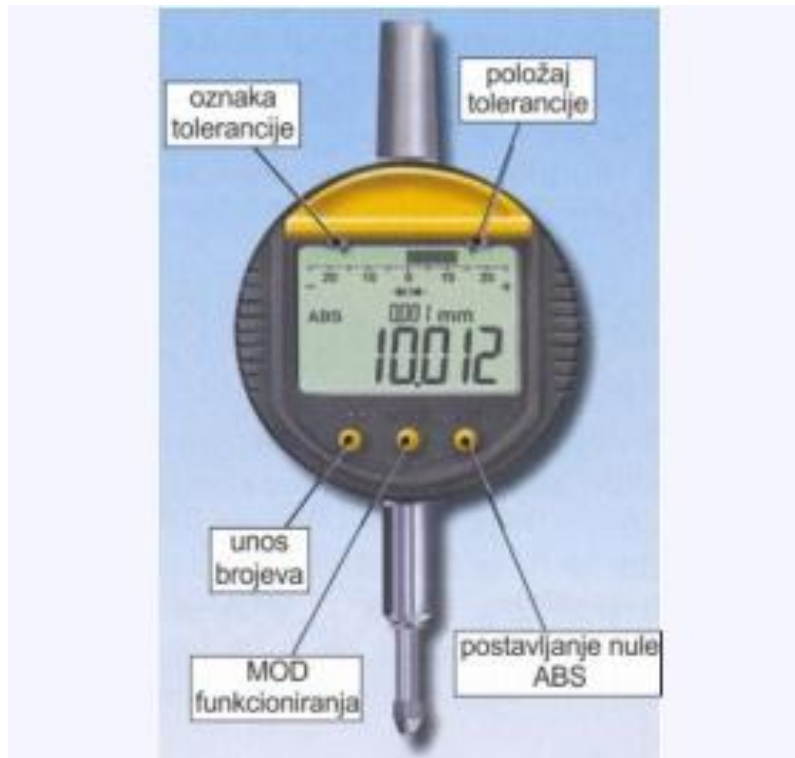
Slika 4. Digitalna mjerna ura [6]
