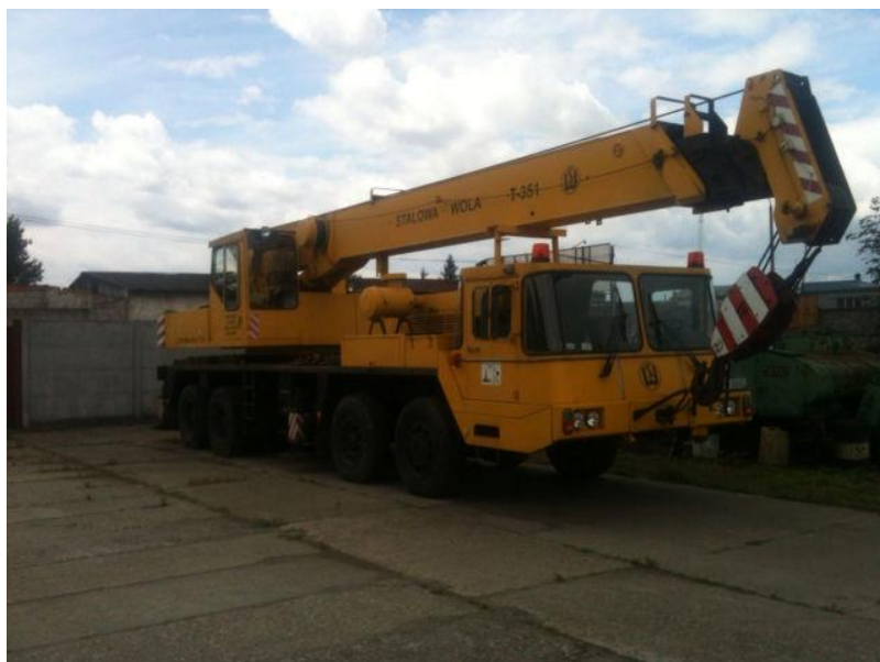
Slika 3.2. Auto dizalica Stalowa Wola 35t.
