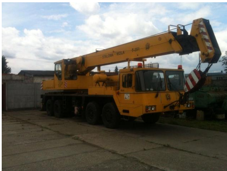
Slika 3.2. Auto dizalica Stalowa Wola 35t.
