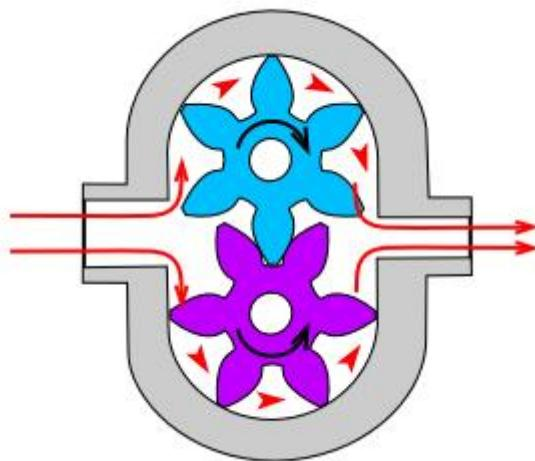
Slika 2.3. Zupčasta pumpa s vanjskim ozubljenjem [2]
