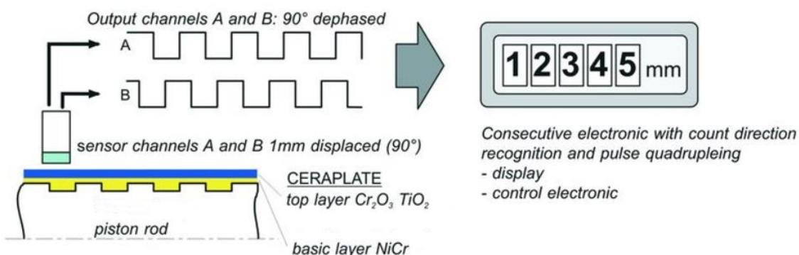
Slika 5.8. Prikaz mjernog signala [7]
