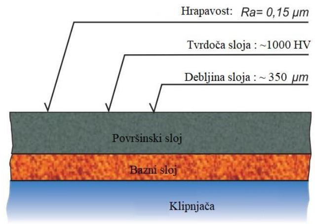
Slika 5.6. Prikaz slojeva na klipnjači, prema [7]
