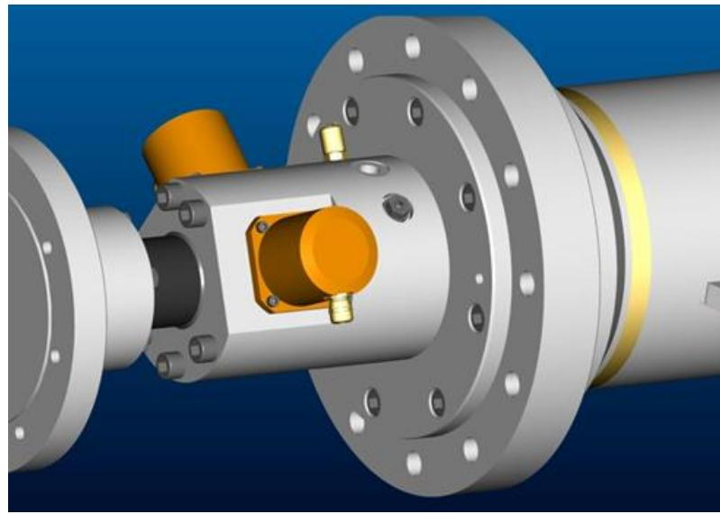
Slika 5.10. 3D model kućišta senzora [7]
