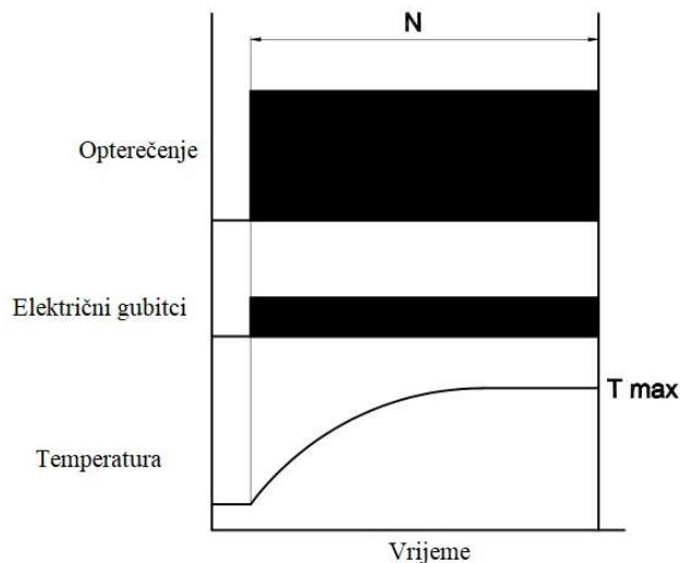
Slika 5.3. Dijagram opterećenja i porasta temperature, prema [4]
