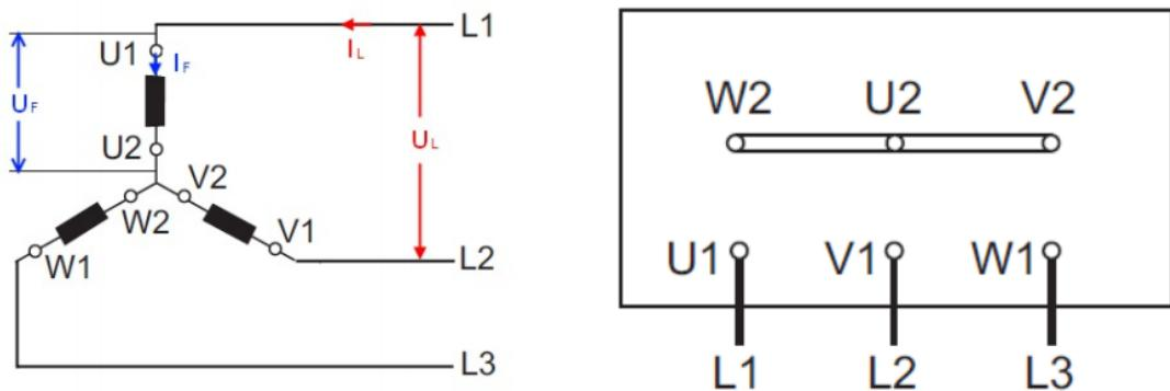
Slika 5.5. Spoj namota i priključišta elektromotora u zvijezdu [5]
