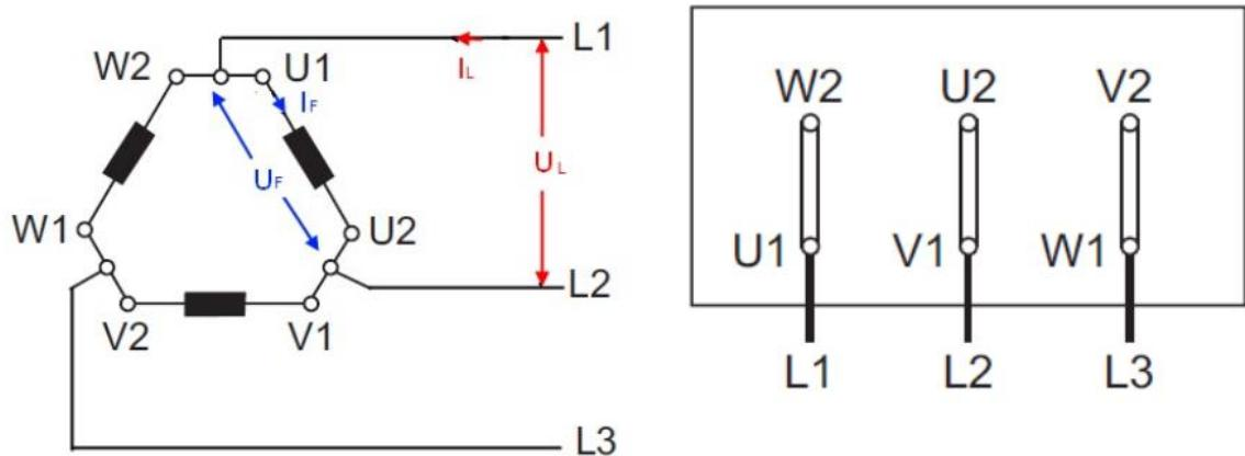
Slika 5.4. Spoj namota i priključišta elektromotora u trokut [5]
