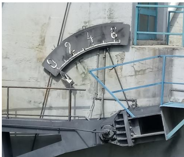
Slika 2.12. Vanjski, mehanički pokazivač položaja
