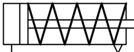
Slika 2.6. Simbol jednoradnog cilindar sa oprugom [2]
