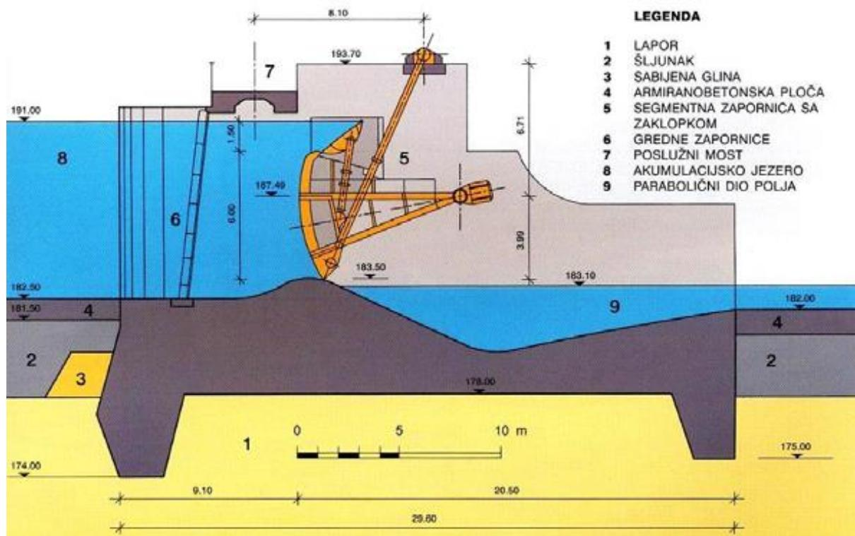
Slika 1.3. Uzdužni presjek preljevnog polja brane HE Varaždin [1]
