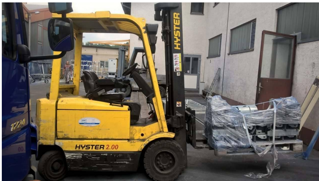
SLIKA 4.11. Čeoni električni viličar Hyster J 2.00 XMT
