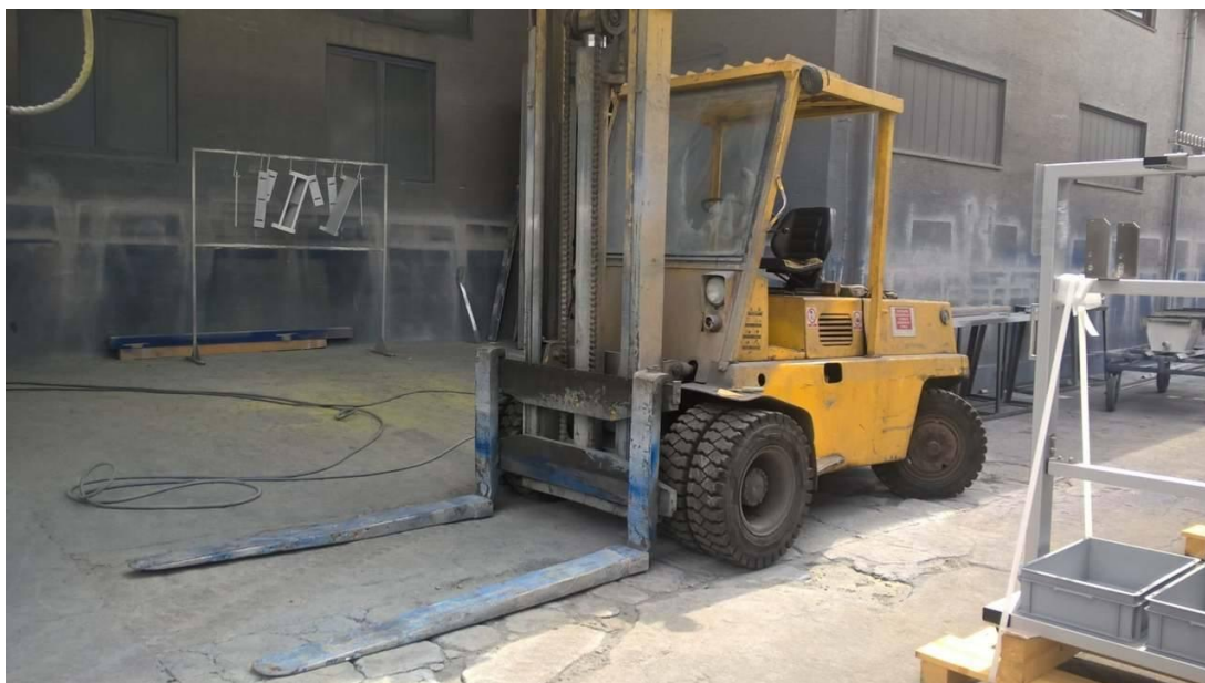
SLIKA 4.8. Čeoni viličar Litostroj 5 t
