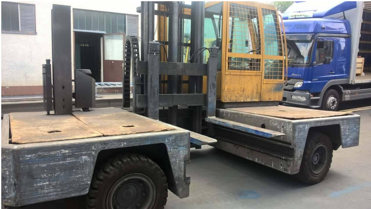
SLIKA 4.10. Bočni viličar Baumann HX50
