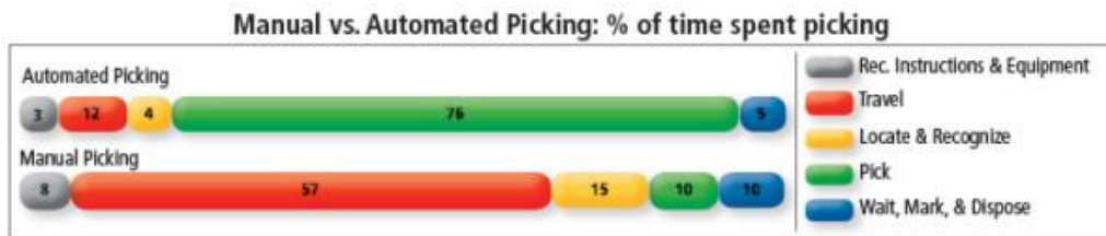
Slika 4.2. Usporedba vremena ručnog i automatiziranog izuzimanja [13]
