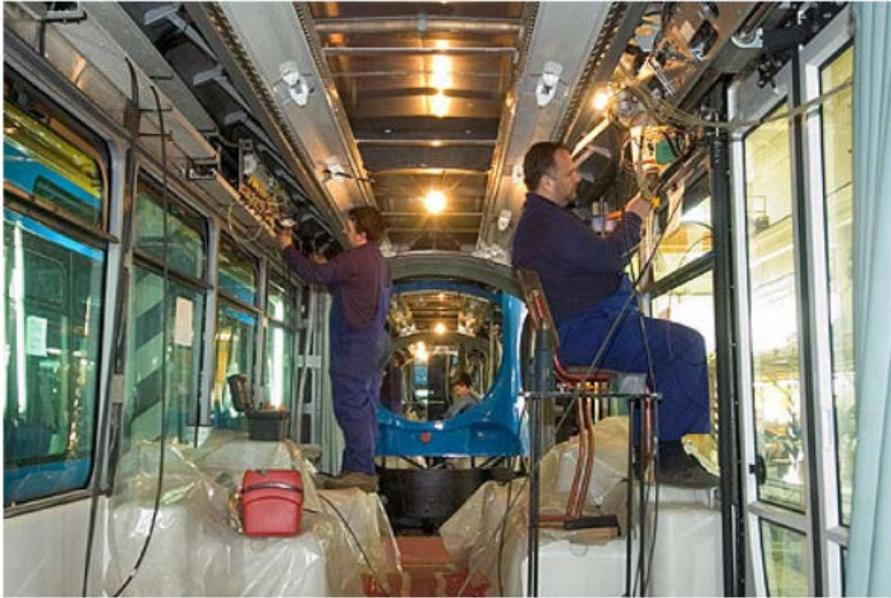
Slika 4.11: Ugradnja elektronike
