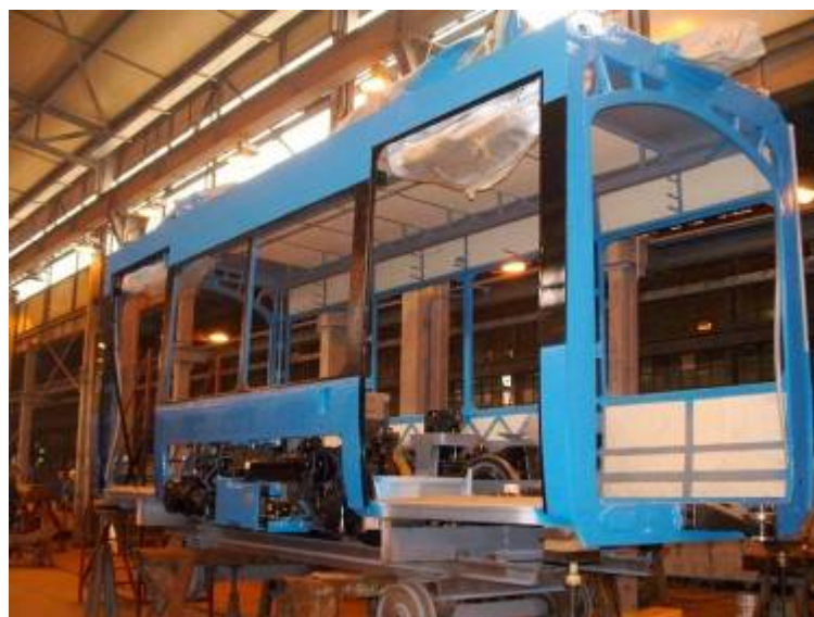
Slika 4.6: Konstrukcija i izrada sanduka za TMK 2200
