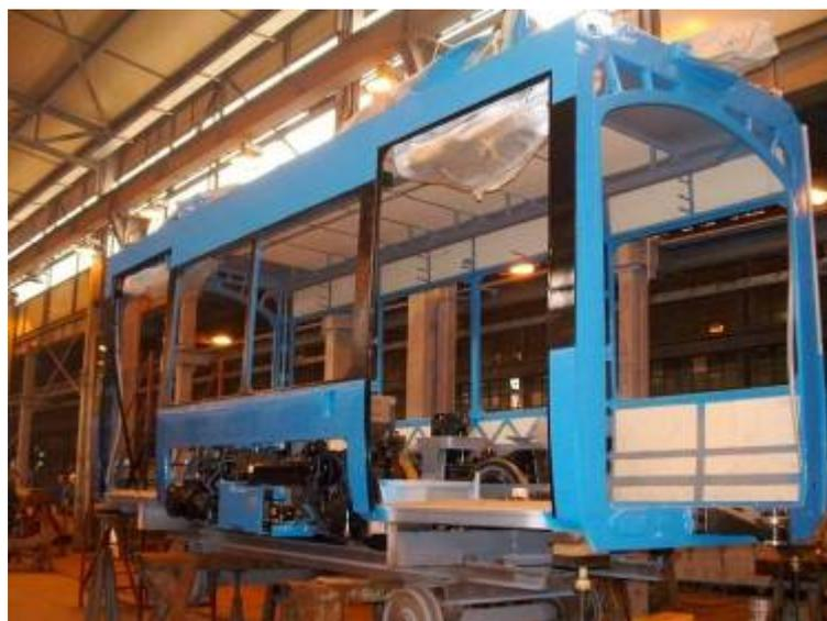
Slika 4.6: Konstrukcija i izrada sanduka za TMK 2200
