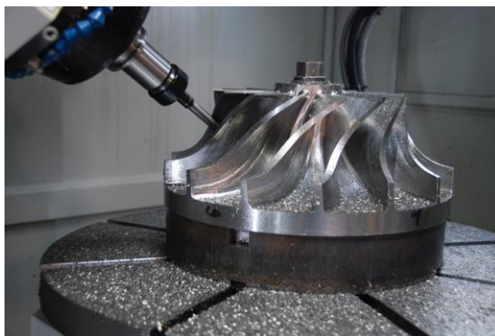
Slika 2.7 Izrada turbine na petoosnoj glodalici
