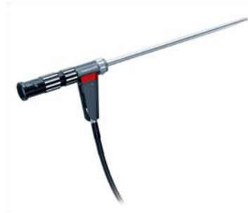
Slika 3.1.2 Boroskop Izvor: www.ndt.com.tr
