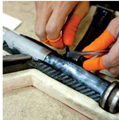
Slika 3.14 Ulaganje slojeva u kalup [11]
