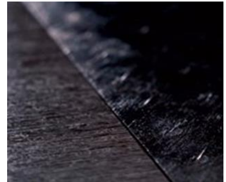
Slika 3.10 Uniform sloj karbona [11]
