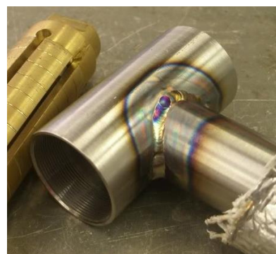
Slika 3.4 Spoj cijevi MIG zavarivanjem [6]
