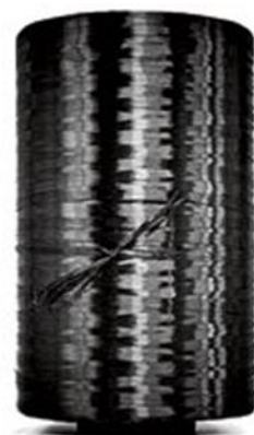
Slika 3.9 Sirovina za proizvodnju karbonskog pletiva [11]
