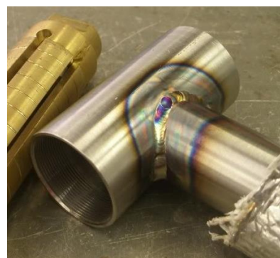
Slika 3.4 Spoj cijevi MIG zavarivanjem [6]
