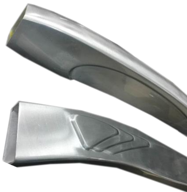
Slika 3.7 Prikaz oblikovanih aluminijskih cijevi [9]
