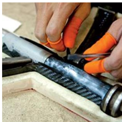
Slika 3.14 Ulaganje slojeva u kalup [11]
