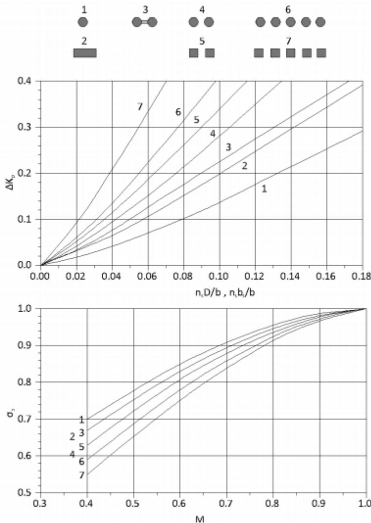
Slika 3.8: Dijagram za određivanje vrijednosti lokalnog gubitka zbog stupova; dijagram daje vrijednosti  $\Delta K_p = \Delta K_p$  za  $M = 1$  (nema suženja) u funkciji parametara  $n_s D/b$  i  $n_s b_s/b$ , gdje je  $n_s$  broj stupova,  $D$  promjer cilindričnih stupova,  $b_s$  širina stupa pravokutnog presjeka,  $b$  širina korita u dnu; za  $M \neq 1$  vrijednosti  $\Delta K_p$  se množe faktorom  $\sigma$
