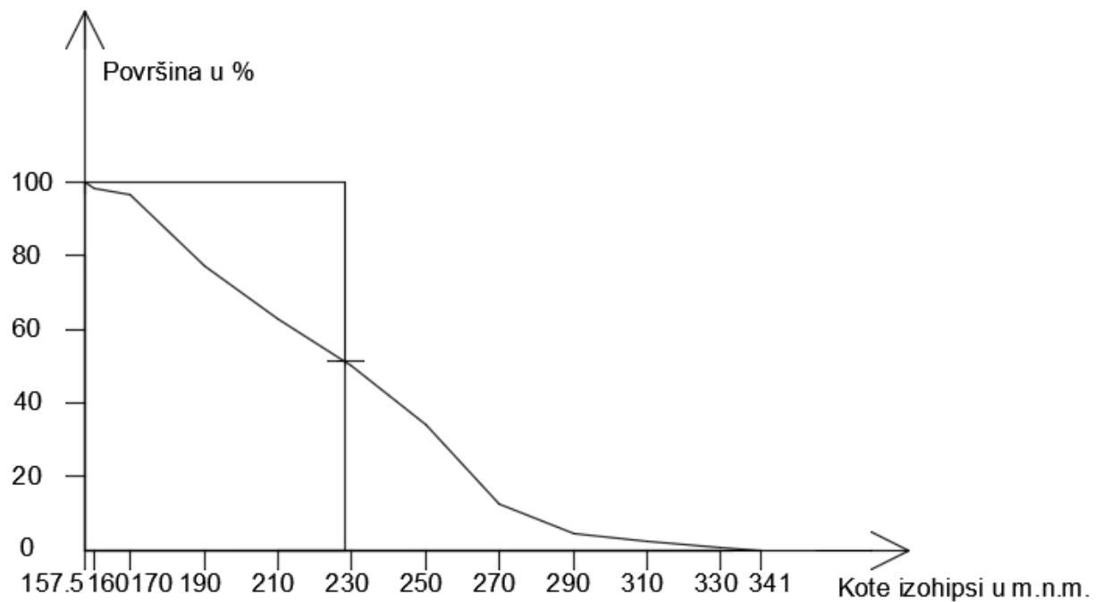
Slika 2.4: Hipsometrijska krivulja; izvor: Autocad
