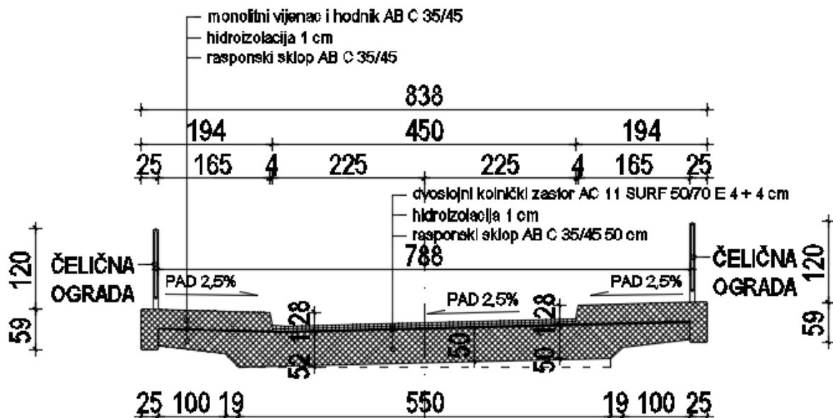
Slika 4.1: poprečni presjek mosta
