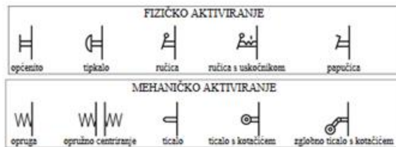
Slika 5.10 Fizički i mehanički način aktiviranja razvodnika [21]
