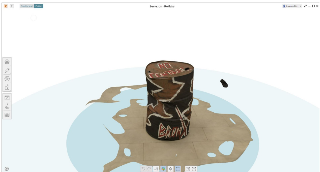
Slika 7.11 Test1 – Rezultat fotogrametrije – generirani 3D model 1
