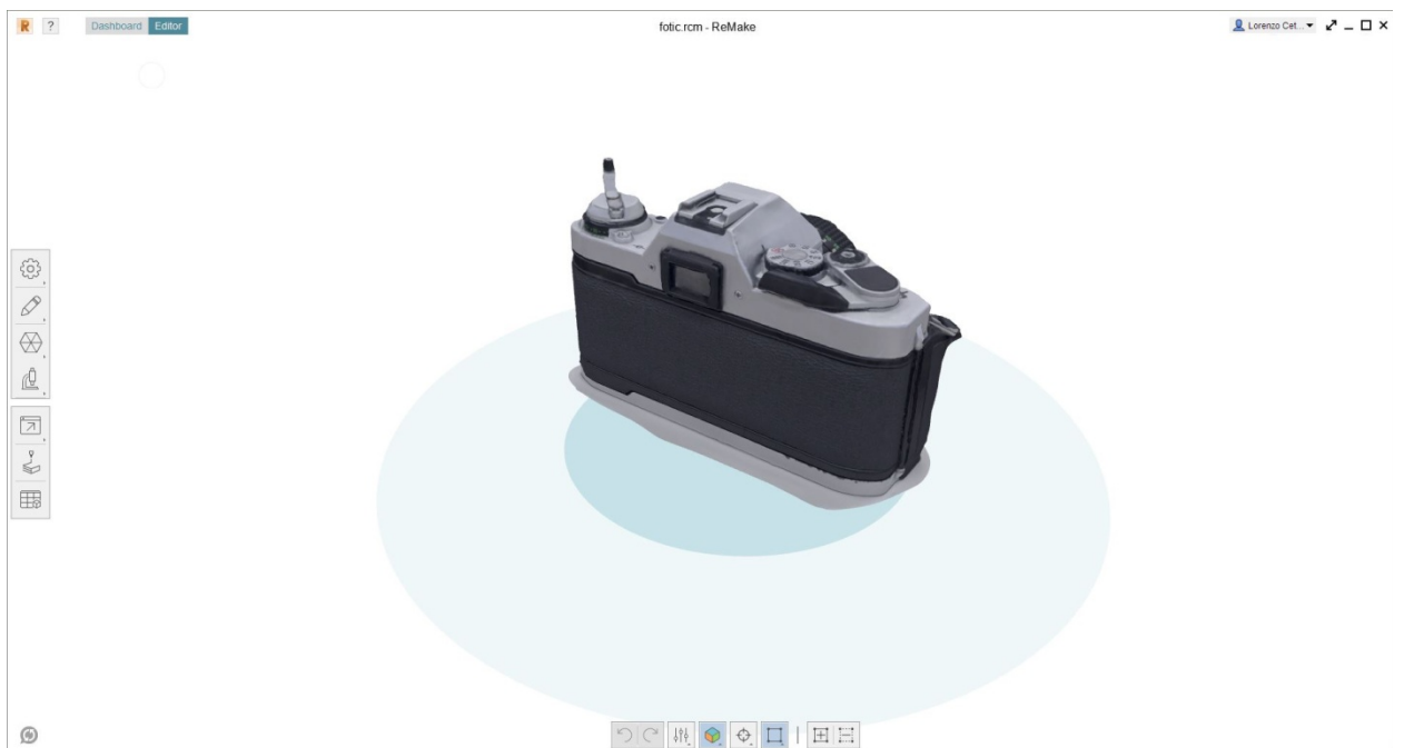
Slika 7.24 Test2 – Rezultat fotogrametrije – generirani 3D model 2
