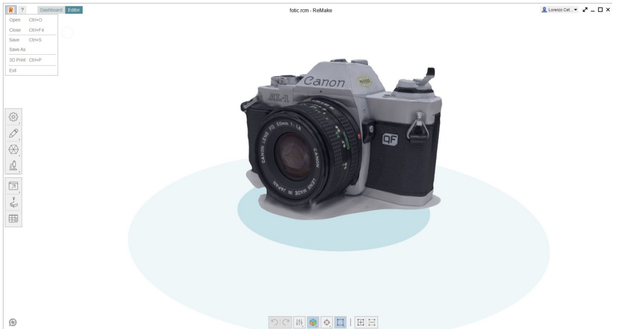
Slika 7.23 Test2 – Rezultat fotogrametrije – generirani 3D model 1
