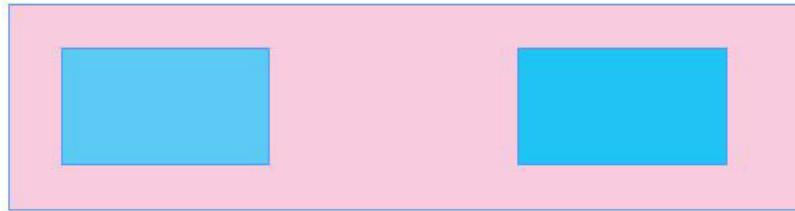
*Slika 8.1. Testni uzorak efekta nabiranja sa sekundarnim stimulusom 25% RTV i primarnim stimulusom 55% i 65% RTV*
