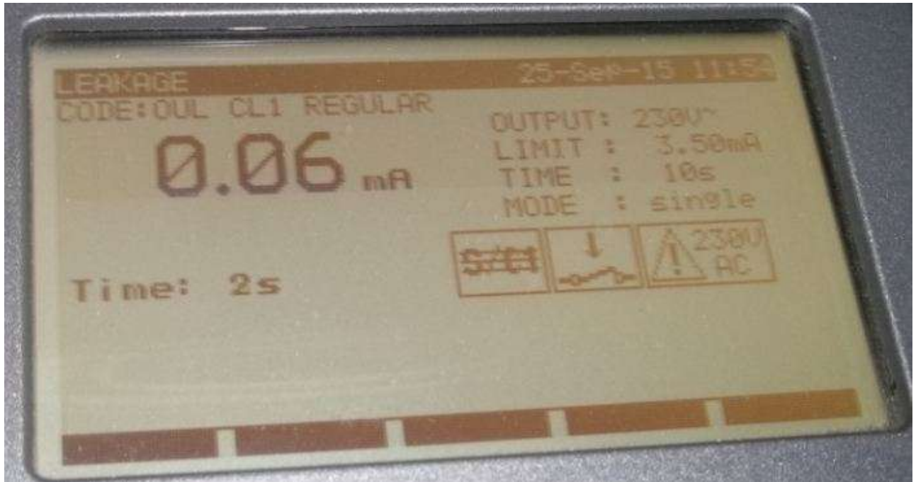
Slika 3.5.3.1. Displej mjerenja struje curenja
