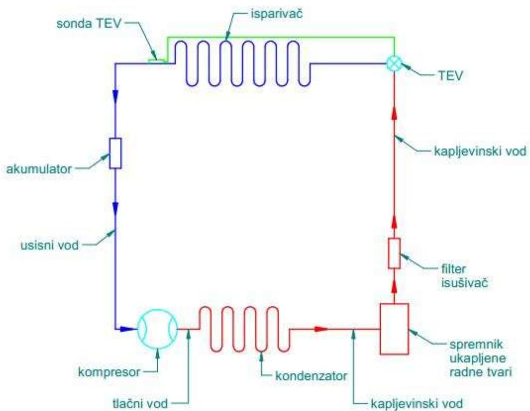
Slika 2.2.Osnovni dijelovi rashladnog uređaja
