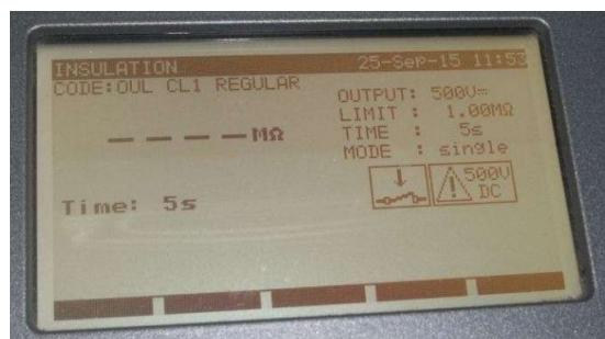
Slika 4.10. Displej mjerenja dielektrične čvrstoće
