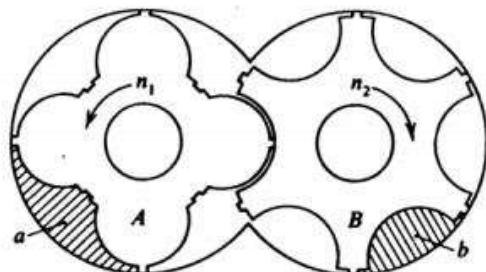
Slika 2.1.1.3.1.. Poprečni presjek vijčanog kompresora
