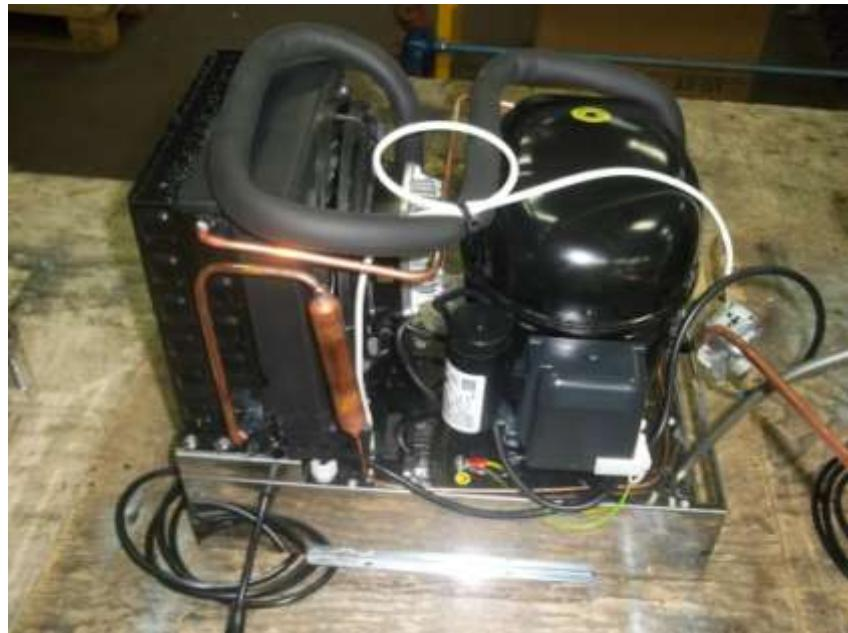
Slika 2.1.2.2.1. Izgled kondenzacijskog agregata
