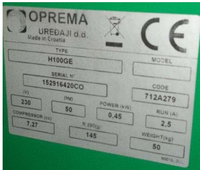
Slika 3.7.2. Naljepnica ispitivanog uređaja
