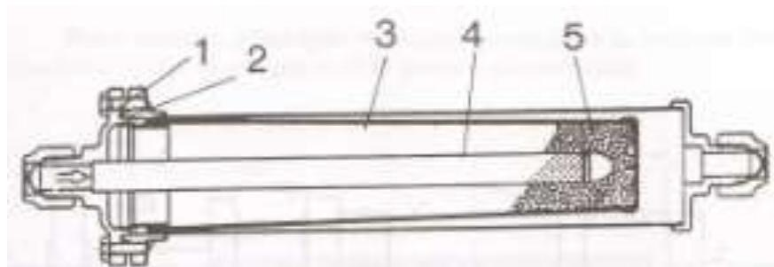
*Slika 2.1.6.4.. Sušač (1-vijak, 2-brtva, 3-mreža, 4-perforirana cijev, 5-apsorbent)*
