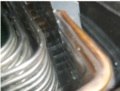
Slika 4.14. Stvaranje leda prilikom mokrog ispitivanja
