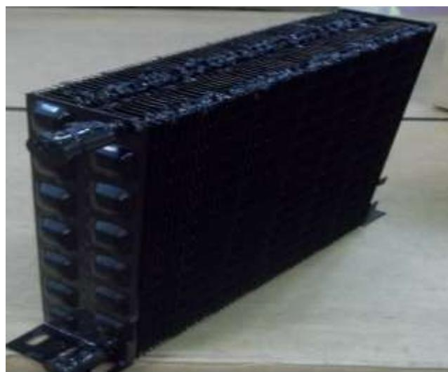
*Slika 2.1.3.1.1.Čelični isparivač*
