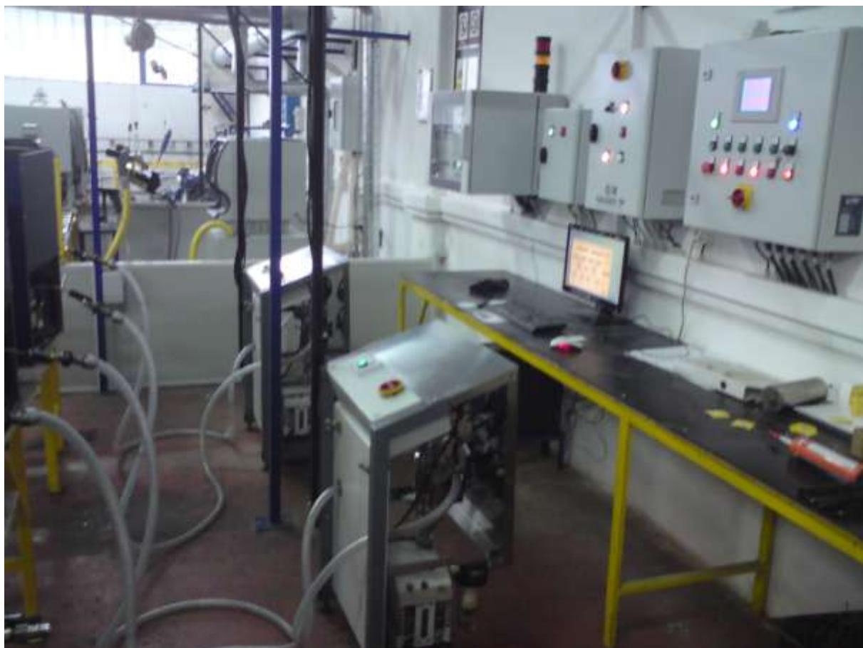
*Slika 3.1.1.Kontrolna stanica vakuumiranja*
