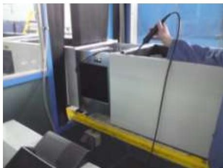
*Slika 4.6.Ispitivanje nepropusnosti*
