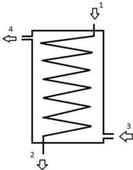
*Slika 2.1.2.1.2. Shema bubenjastog kondenzatora sa potopljenom spiralnom cijevi (1-ulaz pare radne tvari, 2-izlaz prohlađene tekućine, 3-ulaz vode, 4-izlaz vode).*
