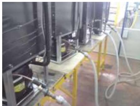
Slika 4.2. Vakuumiranje 4 uređaja
