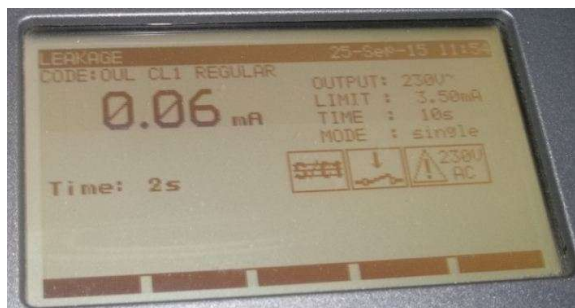
Slika 4.11. Displej mjerenja struje curenja
