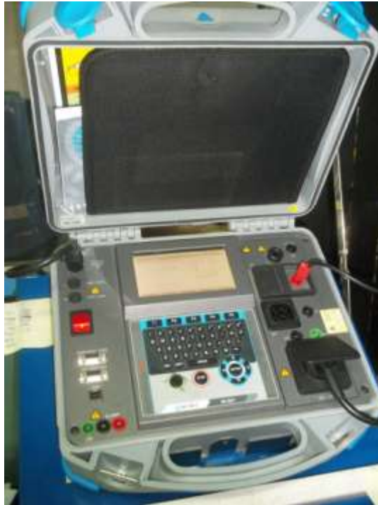
Slika 3.4.1. Uređaj METREL MI 3321
