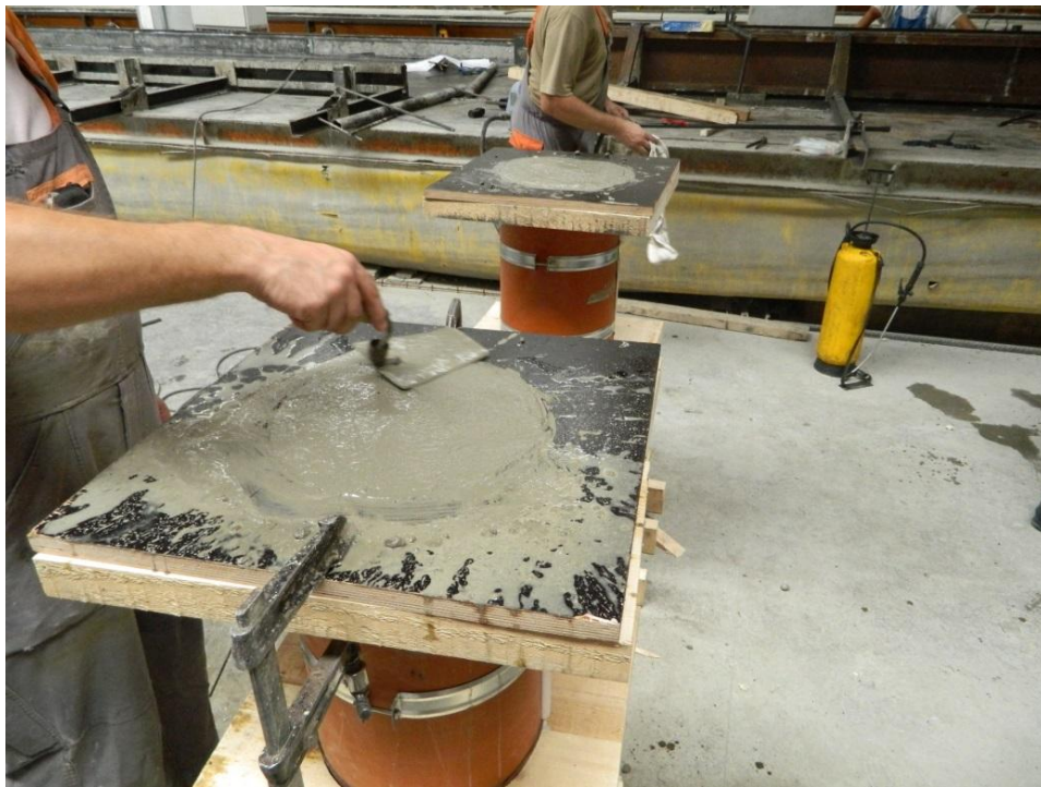
Slika 4. 7 Poravnanje vrha stupa zidarskom žlicom
