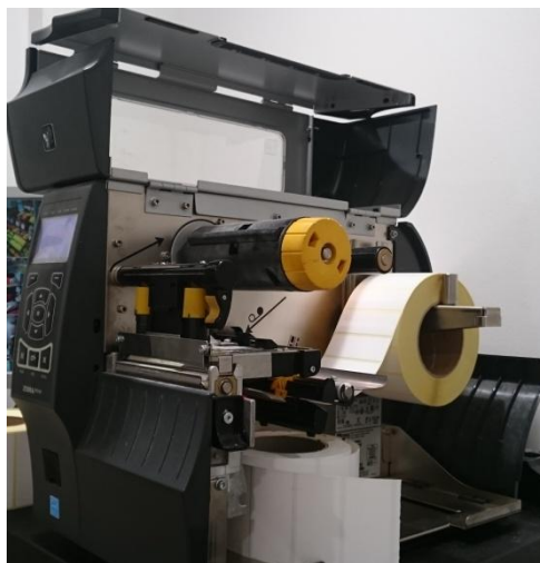
Slika 4.49. Pisač za ispis etiketa i naljepnica s bar kodovima
