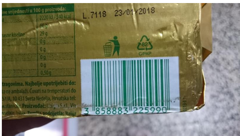
Slika 4.45. Fizičko oštećenje bar koda uzrokovano osjetljivošću artikla
