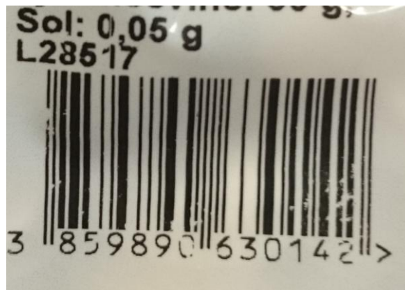
Slika 4.44. Loša kombinacija najlonske ambalaže i tinte
