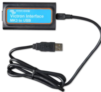
Slika 6.3 Izgled MK3-USB sučelja [23]
