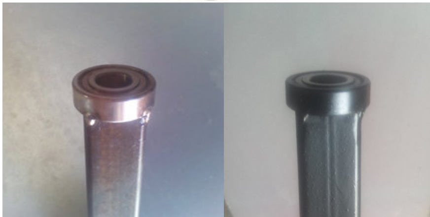
Slika 5.5 Ležaj i položaj ležaja na vrhu stupa
