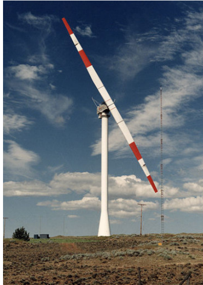
Slika 4.5 Vjetroturbina s dvije lopatice[19]
