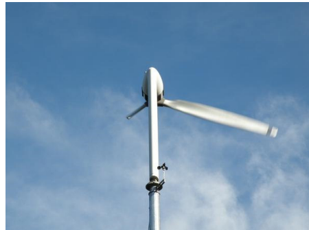
Slika 4.6 Vjetroturbina s jednom lopaticom[20]
