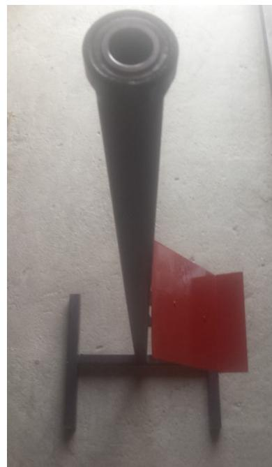
*Slika 5.6 Cjelokupni izgled postolja, stupa i stalka za voltmeter*
