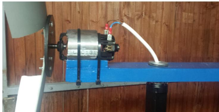
Slika 5.17 Montiranje generatora i postavljanje kabela
