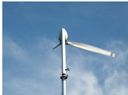
Slika 4.6 Vjetroturbina s jednom lopaticom[20]
