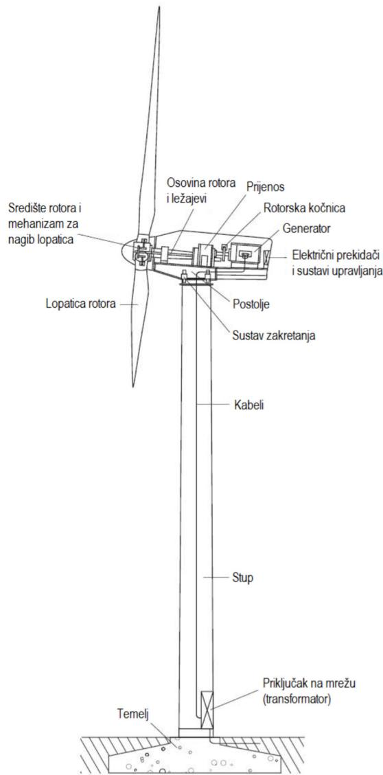
Slika 4.8 Dijelovi vjetroturbine s horizontalnom osi vrtnje [17]
