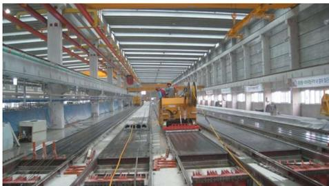
*Slika 3.4. Prikaz strojno istiskivanje betonske mješavine*
