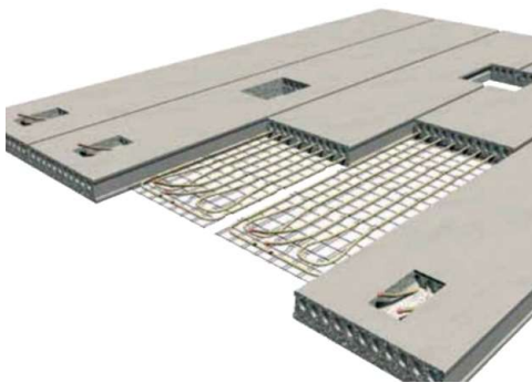
Slika 2.2. Prikaz provođenja instalacija kroz šupljine
