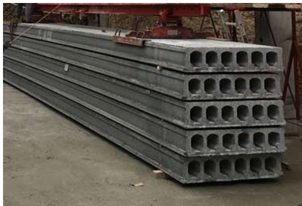
Slika 3.5. Gotove prednapregnute šuplje ploče
