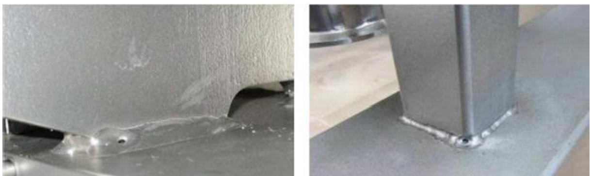
Slika 39. Pojedinačne pore i rupe u zavaru
