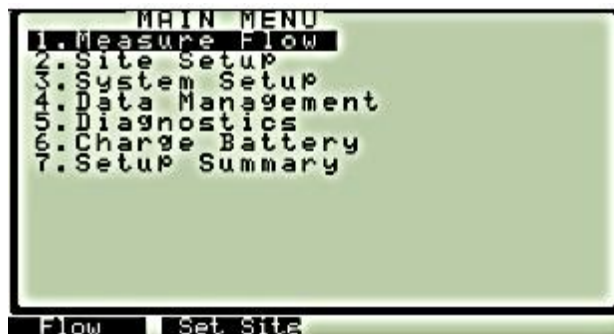
Slika 3.15 Odabir mjerenja protoka, ChronoFLO2[2]
