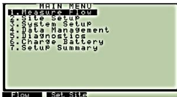
Slika 3.15 Odabir mjerenja protoka, ChronoFLO2[2]
