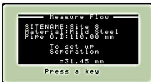
Slika 3.16 Izračun udaljenosti između pretvornika, ChronoFLO[2]
