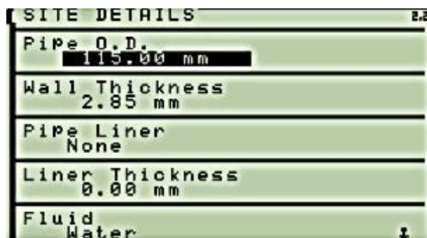
Slika 3.14 Upisivanje parametara, ChronoFLO 2[2]
