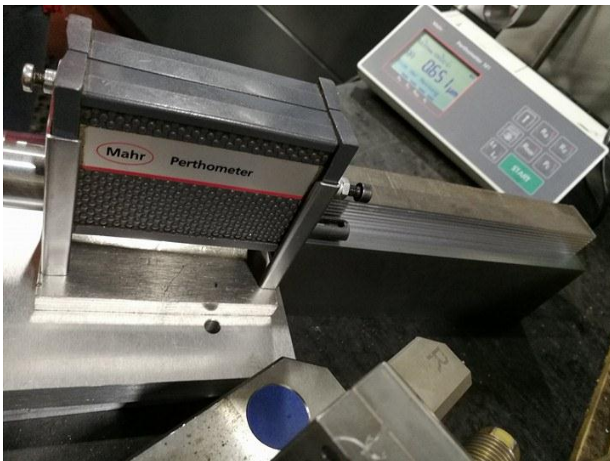
Slika.4.9 Uređaj za mjerenje hrapavosti korišten u testiranju.
