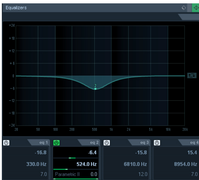
Slika 5.5: Ujednačavanje frekvencija bas gitare
