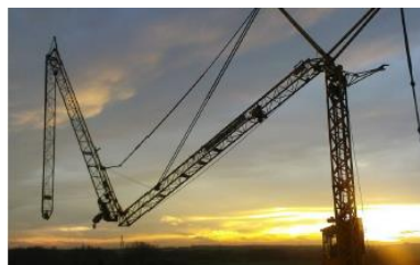
Slika 42. Toranjska dizalica s lomljivom rukom
