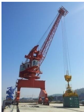
Slika 40. Toranjska dizalica s kosom rukom
