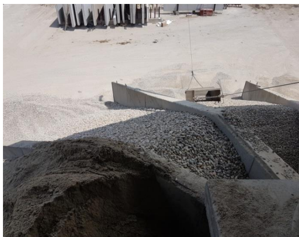
Slika 65. Kameni agregat raznih frakcija za proizvodnju betona
