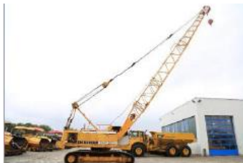
Slika 44. Mobilne dizalice na gusjenicama
