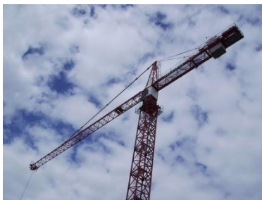
Slika 41. Toranjska dizalica s vodoravnom rukom
