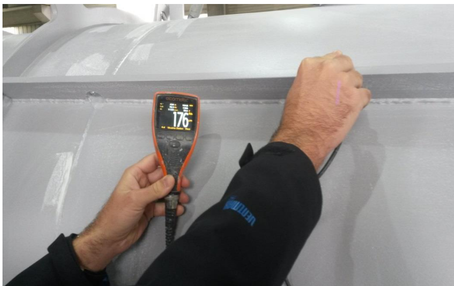
Slika 19. Mjerenje debljine suhog filma međusloja premaza
