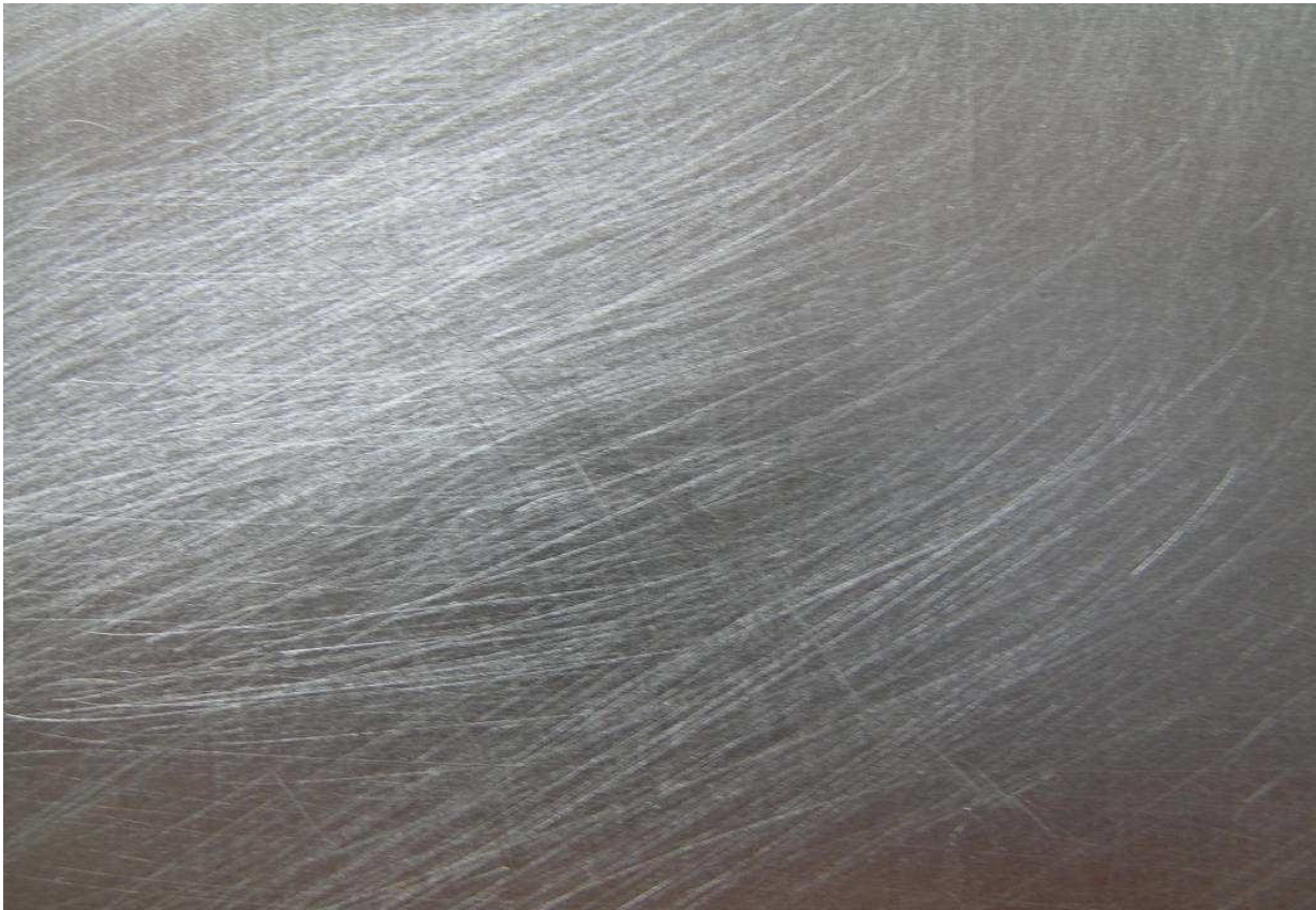
Slika 6. Mehanički očišćeni dekapirani čelični lim
