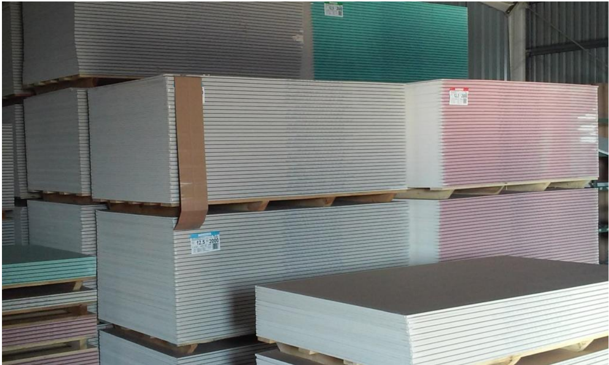
Slika 3.2. Gipskartonske ploče u bojama prema namjeni
