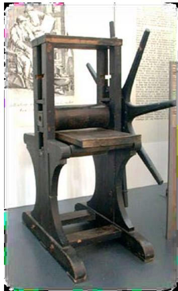
Slika 1. Guttenbergov tiskarski stroj
