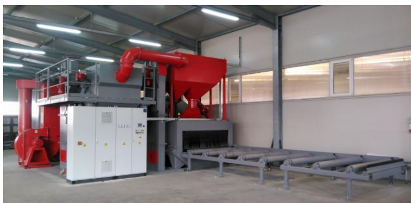
Slika 4.2 Protočni stroj za sačmarenje s valjkastim transporterom [3]
