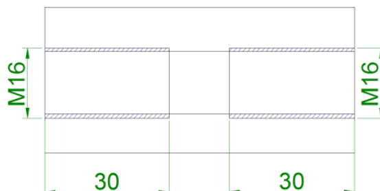
Slika 4.26 Urezivanje navoja M16
