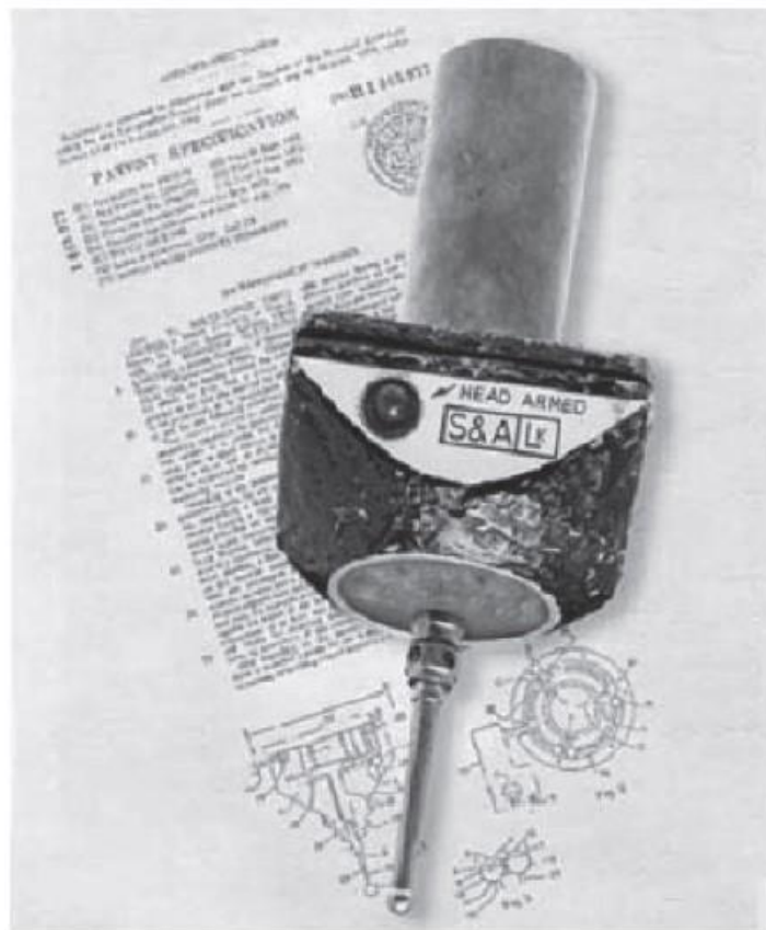
Slika 11. Prvo dodirno mjerno ticalo koje je izumio Sir David McMurtry 1972. godine
