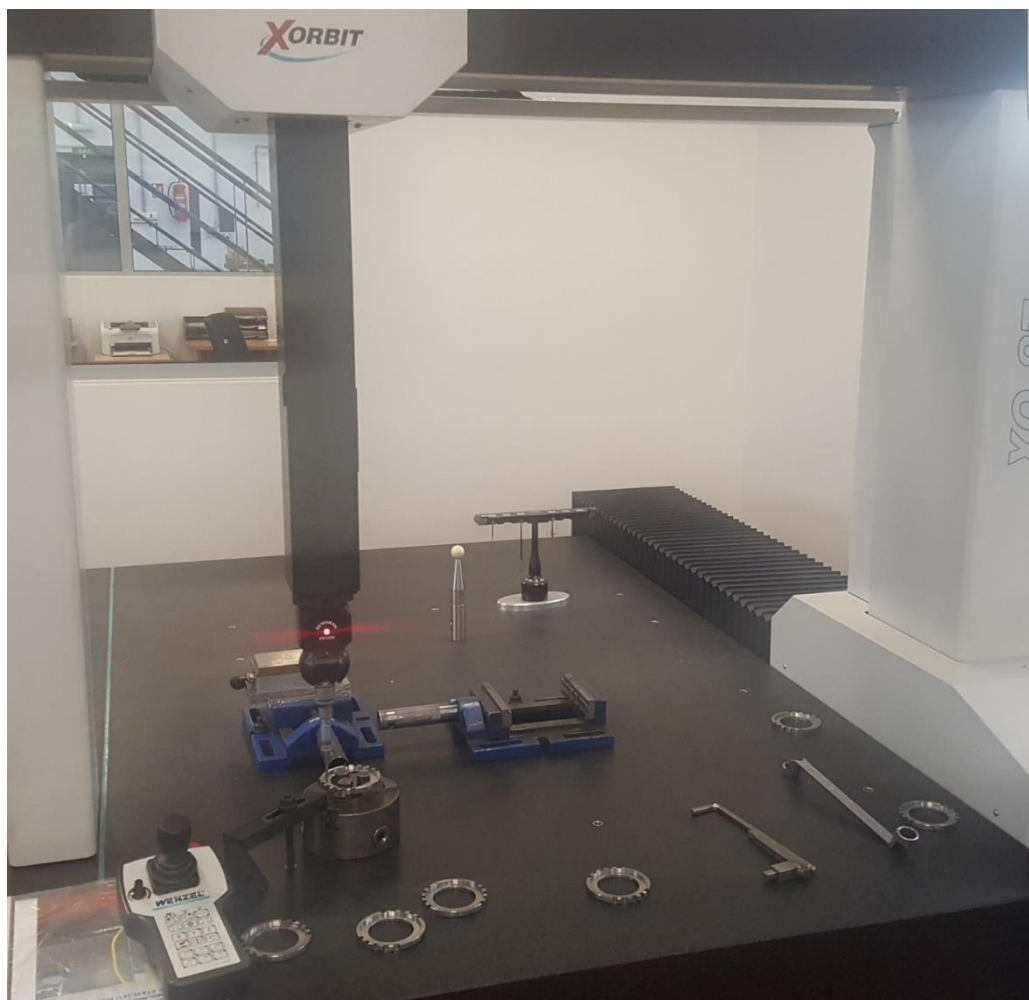
Slika 35. Prikaz mjerenja prvog komada
