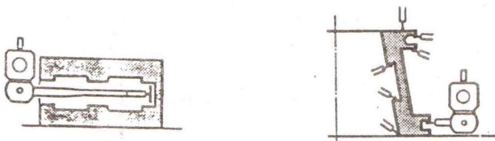
Slika 16. Primjene motoriziranih mjernih sondi [12]
