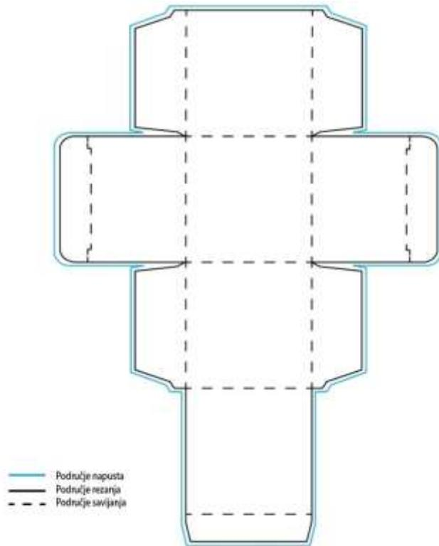
Slika 15. Područje napusta, rezanja, savijanja i perforiranja kutije
