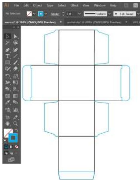
Slika 14. Preklopni dijelovi i dio za perforaciju kutije
