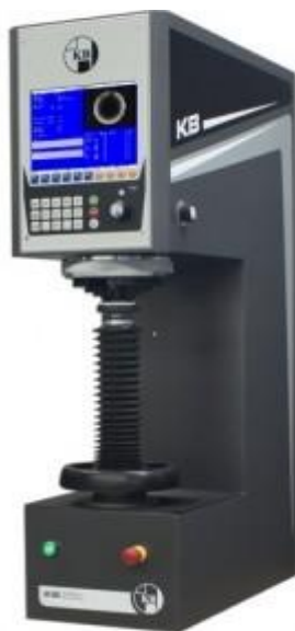
Slika 15. Uređaj za ispitivanje tvrdoće po Brinellu [17]
