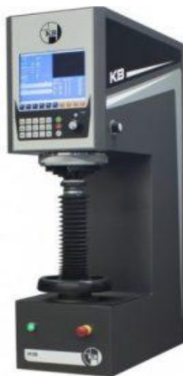
Slika 17. Aparat za ispitivanje tvrdoće po Rockwellu [17]
