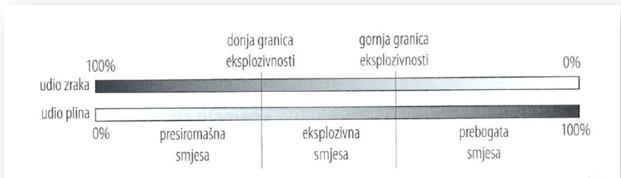
Slika 4.19 Područje eksplozivnosti između granica eksplozivnosti 20
