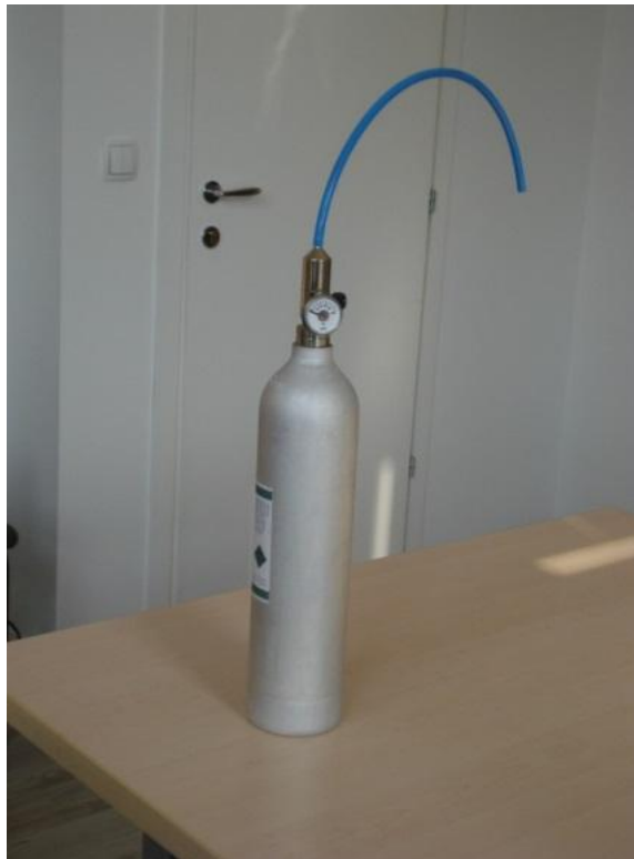
Slika 4.11 Test boca za provjeru ispravnosti uređaja
