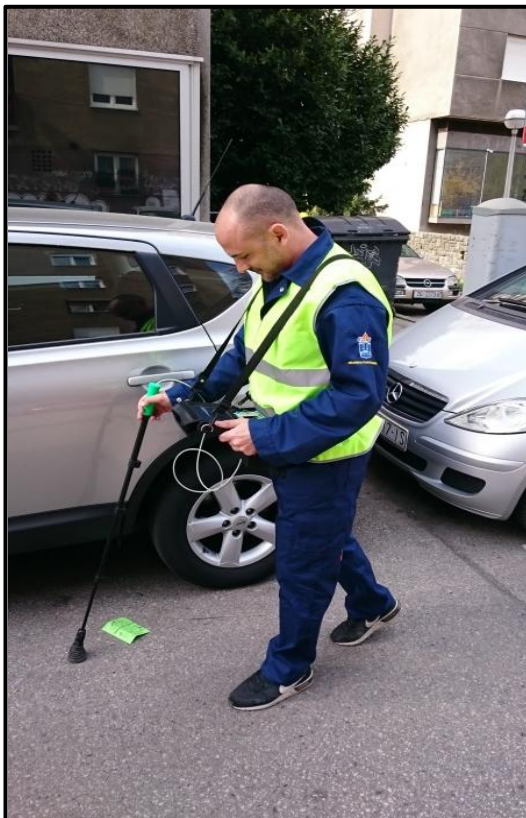
Slika 4.6 Prikaz ispitivanja nepropusnosti operativnih ekipa na terenu
