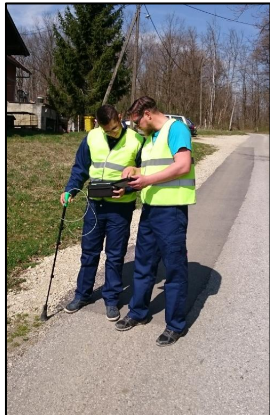
Slika 4.6 Prikaz ispitivanja nepropusnosti operativnih ekipa na terenu
