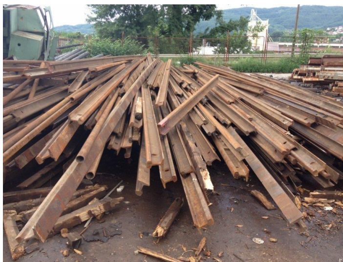
Slika 29. Potrošene tračnice deponirane nakon remonta pruge [11]
