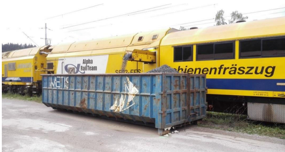
Slika 31. Istovar otpada (špene) u metalni kontejner [13]
