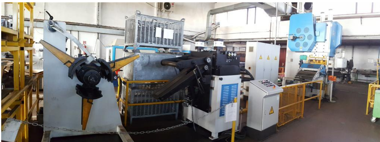
Slika 9.5.3. Linija za štancanje sa prešom 200 tona
