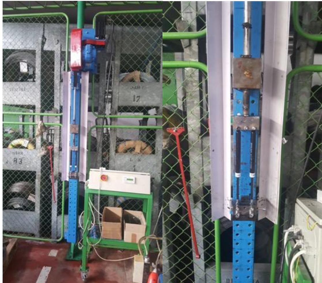
Slika 9.3.1. Stroj za testiranje sila i trajnosti plinskih opruga
