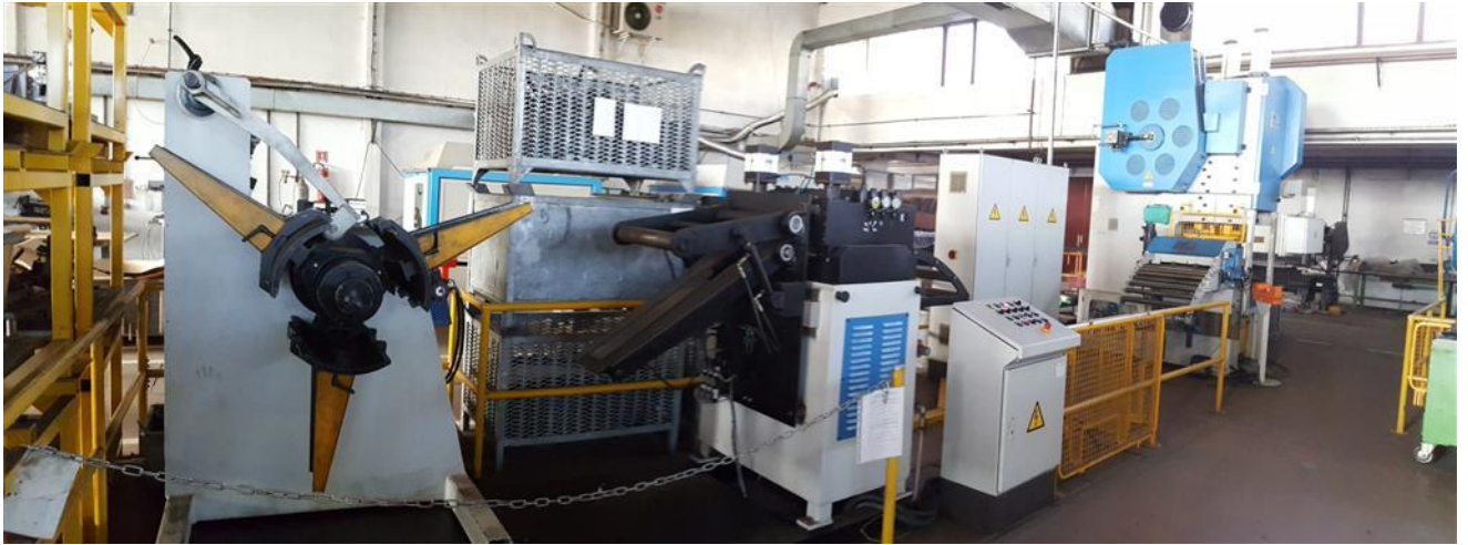
Slika 9.5.3. Linija za štancanje sa prešom 200 tona
