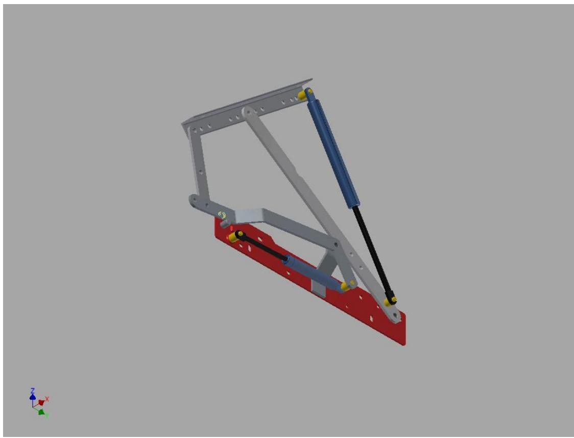
Slika 2.10. Primjer mehanizam sa funkcijom „horizontalnog podizanja“ - prednja strana
