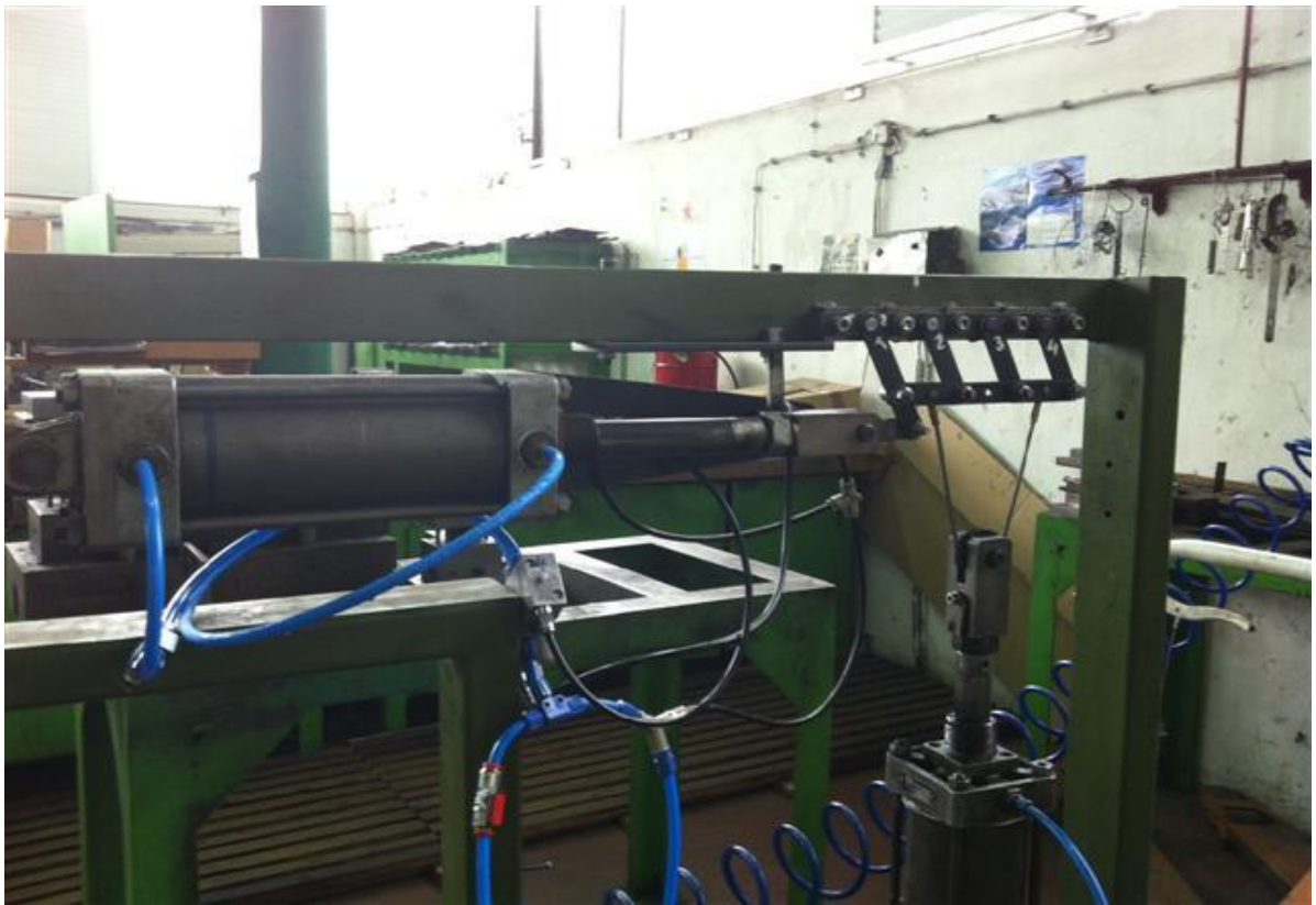
Slika 9.4.3. Naprava za testiranje zakovica i zakovanih spojeva
