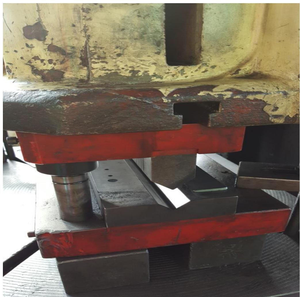
*Slika 9.5.5. Univerzalni alat za savijanje pozicija*
