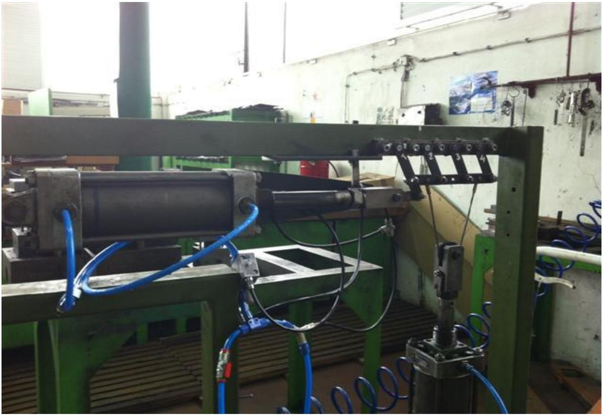
Slika 9.4.3. Naprava za testiranje zakovica i zakovanih spojeva
