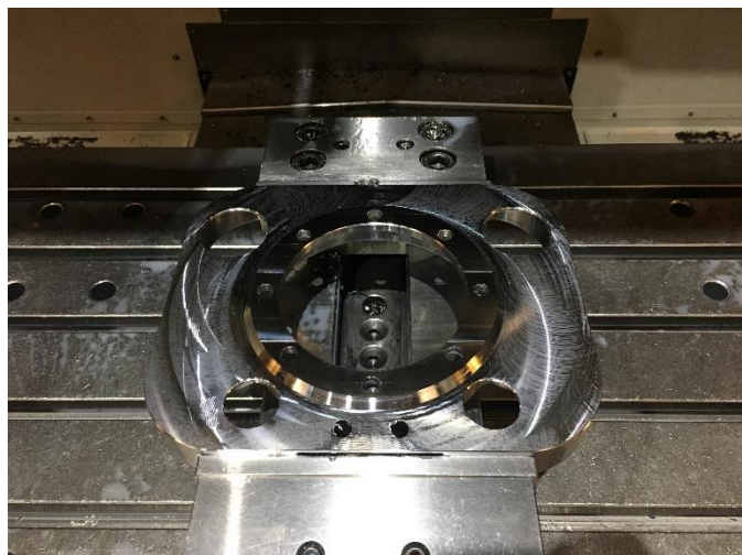
Slika 8.10 Čeono glodanje (izrada konture) [8]
