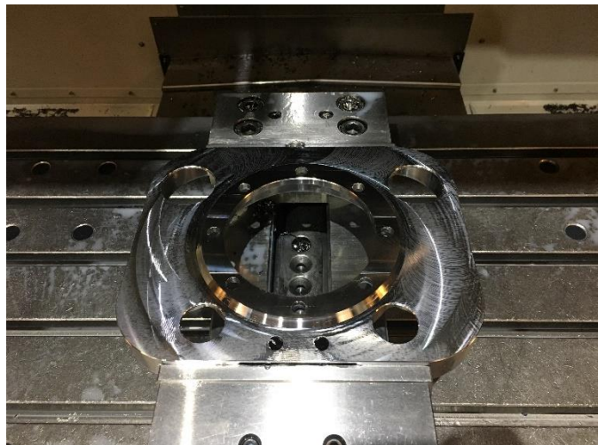
Slika 8.10 Čeono glodanje (izrada konture) [8]
