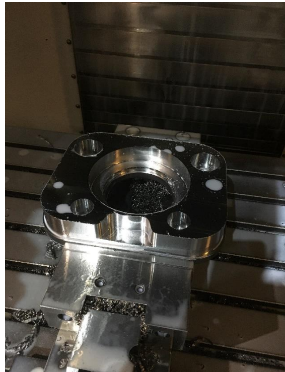
Slika 8.6 Glodanje vanjske konture [8]
