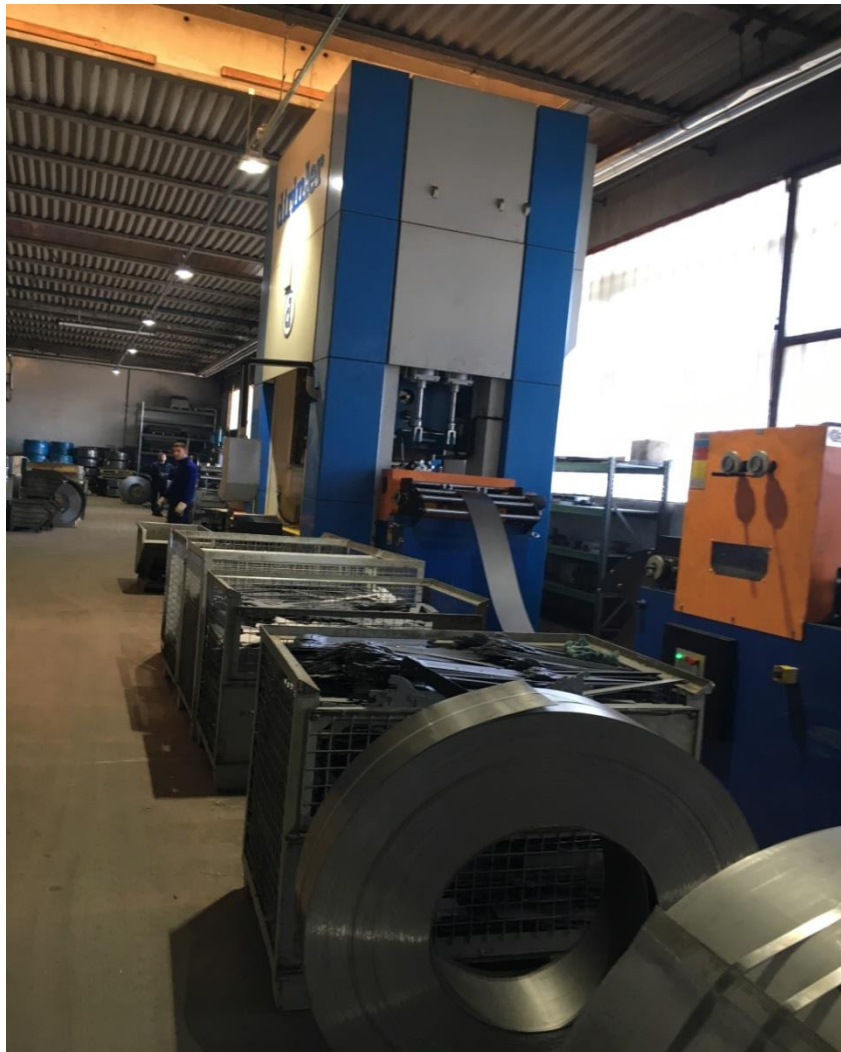
Slika 2. Štanca Dirinler COCK4000 PMU[1]
