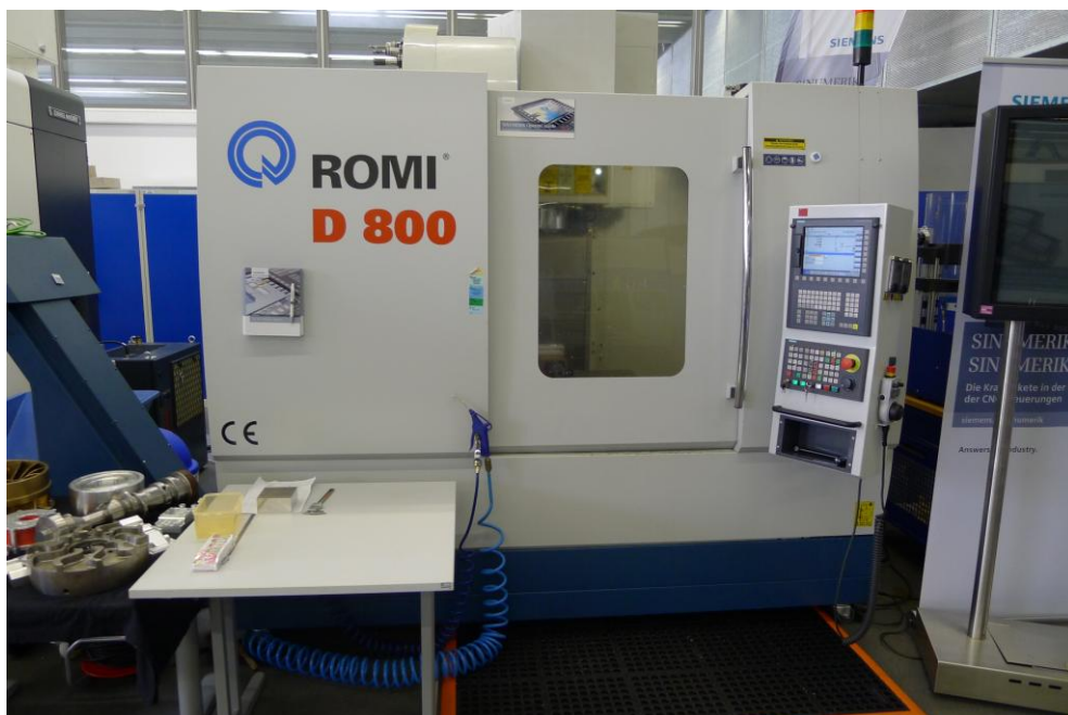
Slika 6.42. CNC glodalica Romi D800 sa Sinumerik 828D upravljanjem
