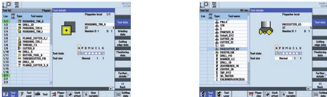
Slika 3.5. Sinumerik programsko sučelje za upravljanje alatima [1]
