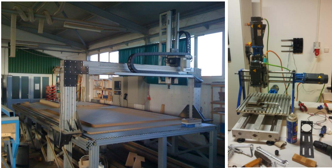
Slika 2.1. Primjer industrijske "Gantry" izvedbe CNC glodalice sa tri osi [10] (lijevo) i korištene edukacijske CNC glodalice [16] (desno)
