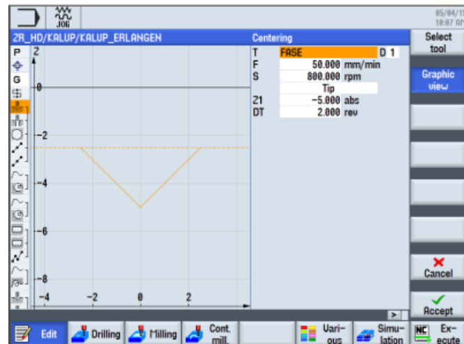
Slika 6.25. Postavljanje parametara za zabušivanje [4]
