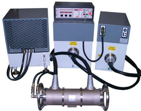
Slika 5. Standardna operama industrijskog aparata za ispitivanje x-zrakama [2]
