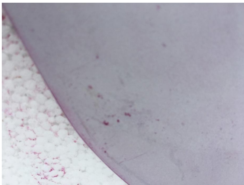
Slika 31. Uočene površinske nepravilnosti na oštrici uslijed nepravilnog poliranja [autorska]
