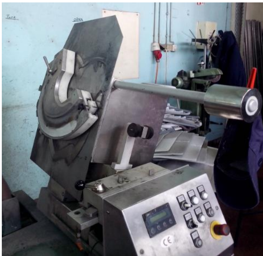
Slika 14. Šablona za brušenje noževa [autorska]
