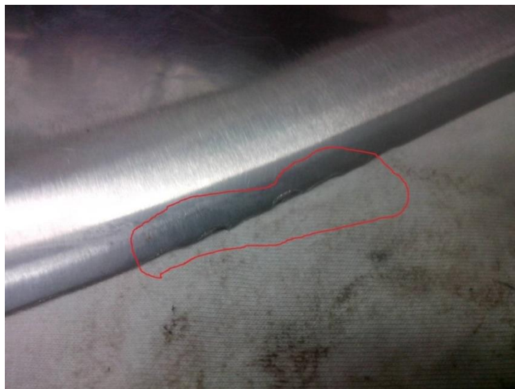
Slika 18. Oštećenje oštrice [autorska]
