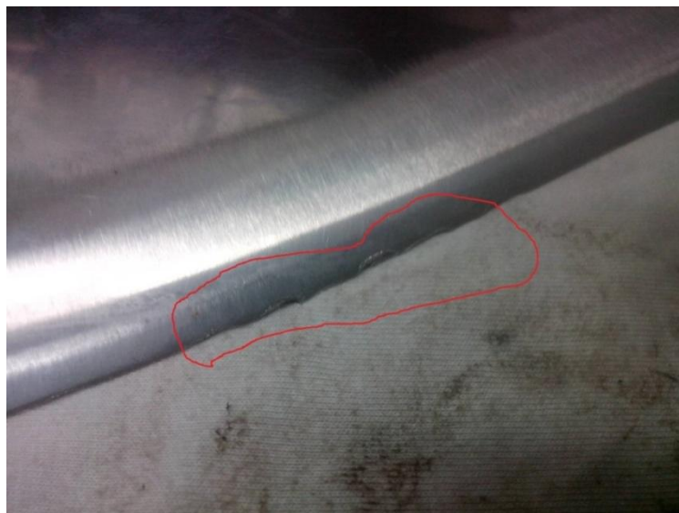
Slika 18. Oštećenje oštrice [autorska]
