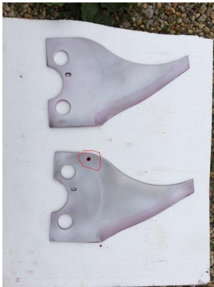
Slika 30 . Uočena površinska pogreška [autorska]
