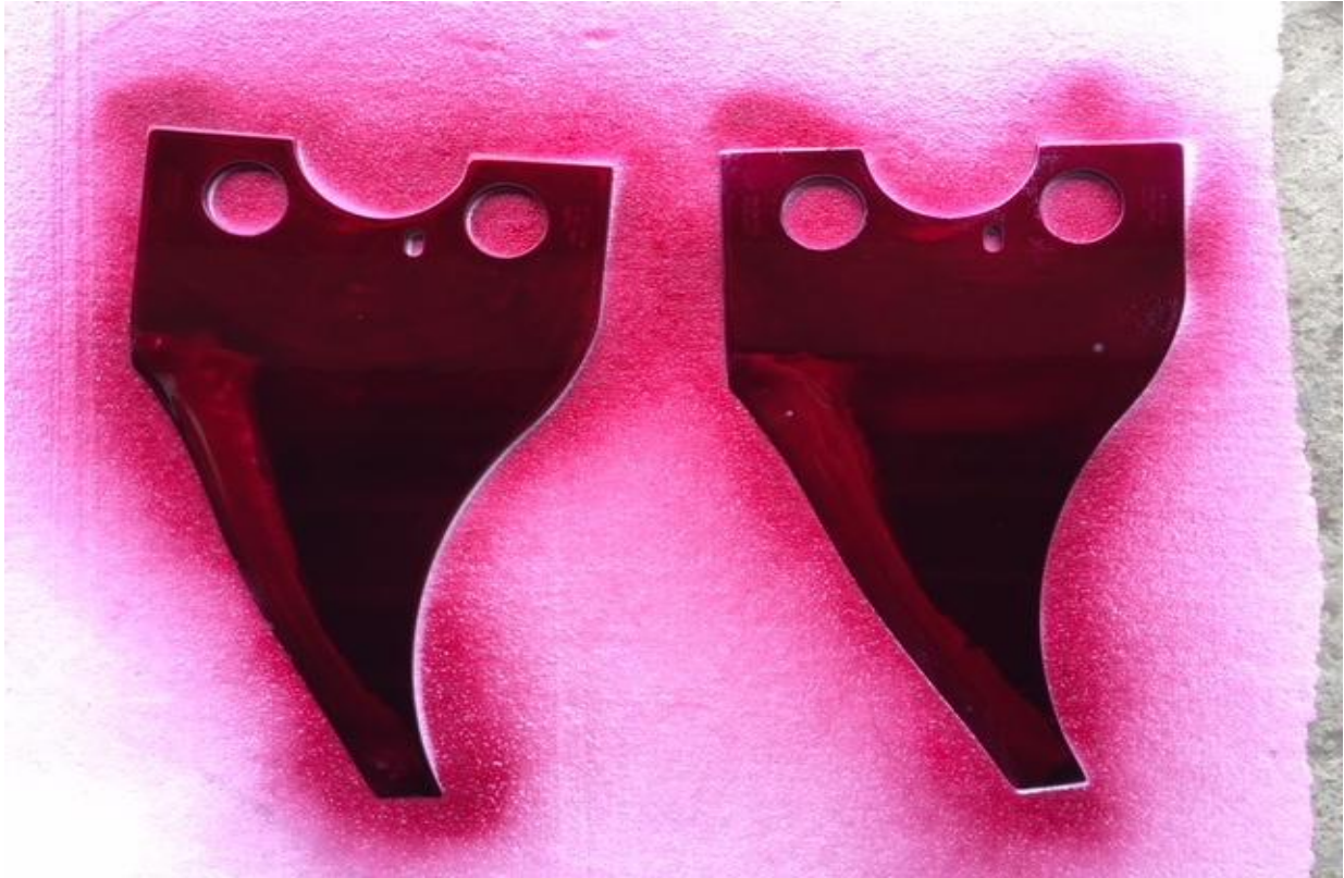
Slika 28. Nanošenje penetranta [autorska]
