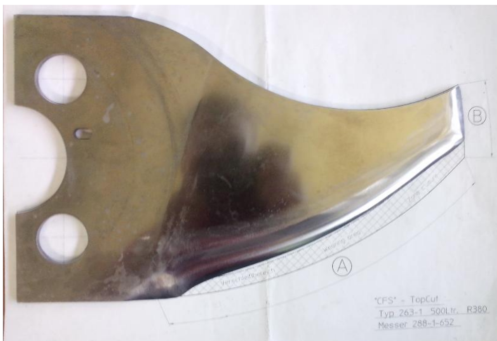
Slika 22. Neispravan nož – prebrušen [autorska]
