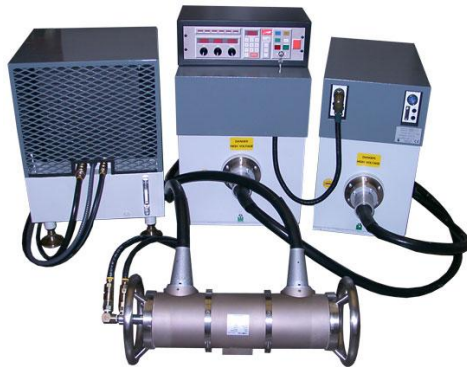
Slika 5. Standardna operama industrijskog aparata za ispitivanje x-zrakama [2]
