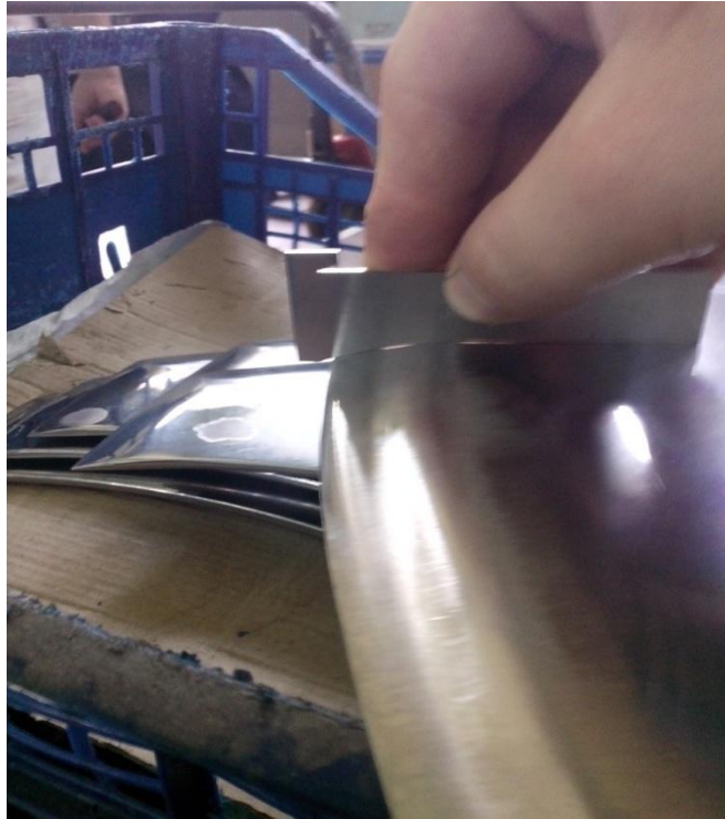
Slika 17. Provjera radijusa oštrice [autorska]
