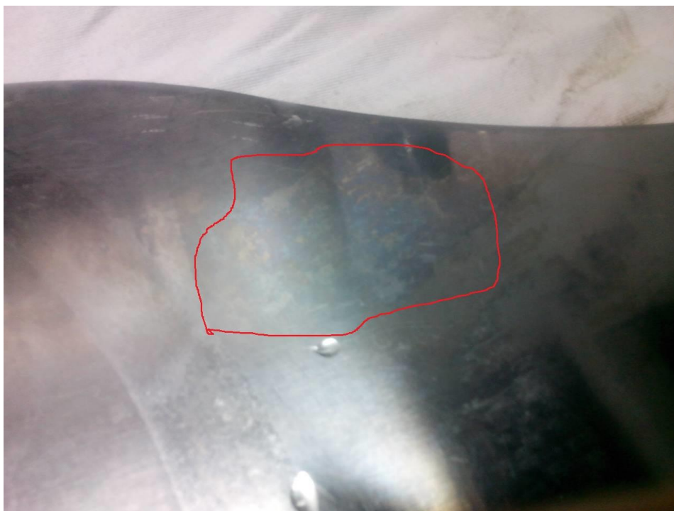
Slika 20. Vidljiva promjena boje nakon brušenja – neispravan nož [autorska]
