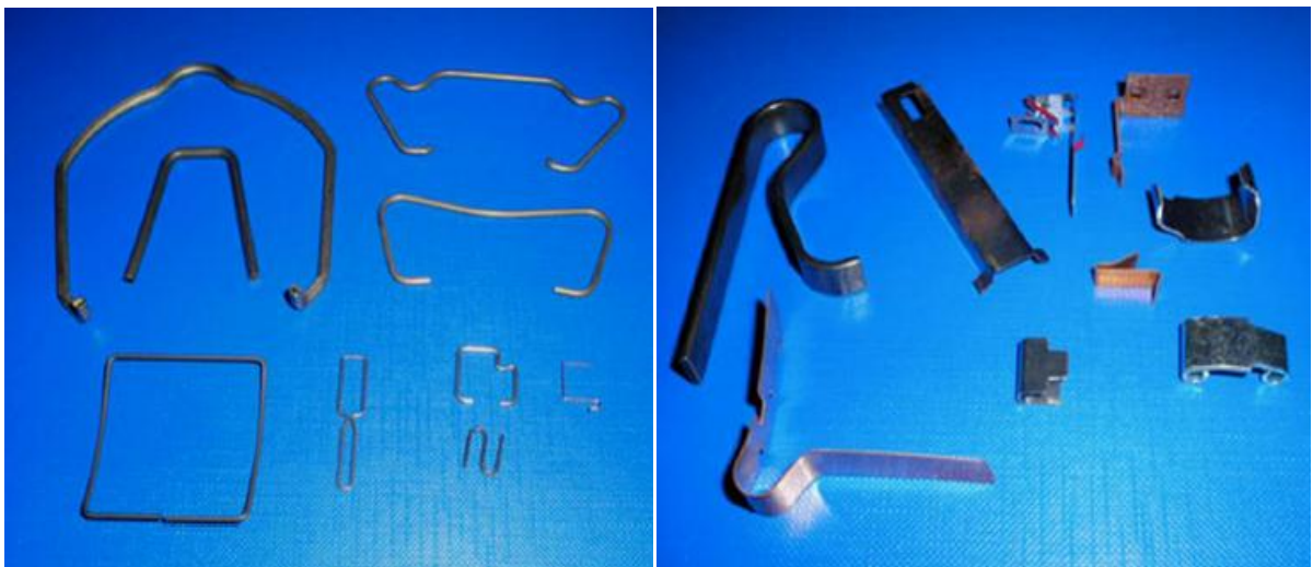
Slika 5.6 Proizvodni asortiman odjela Prosijecanje i savijanje (proizvodi iz žice i trake)
