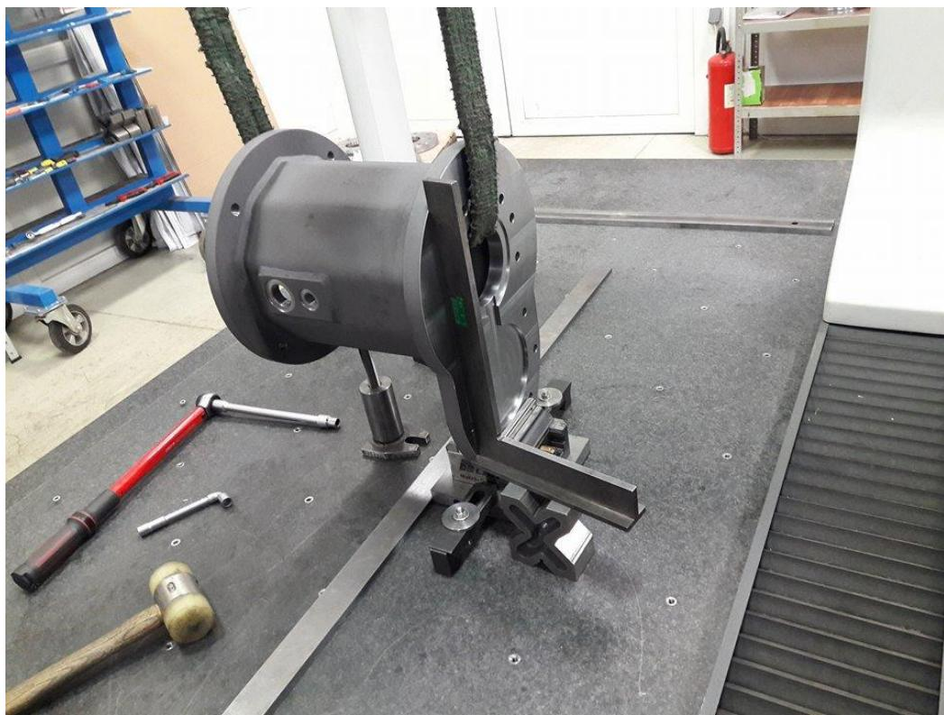
*Slika 17.Pozicioniranje proizvoda na stolu mjernog uređaja*
