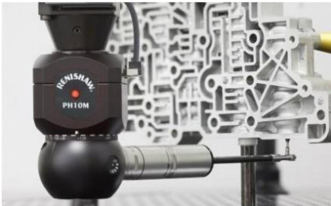
*Slika 12. Motorizirana mjerna sonda [8]*
