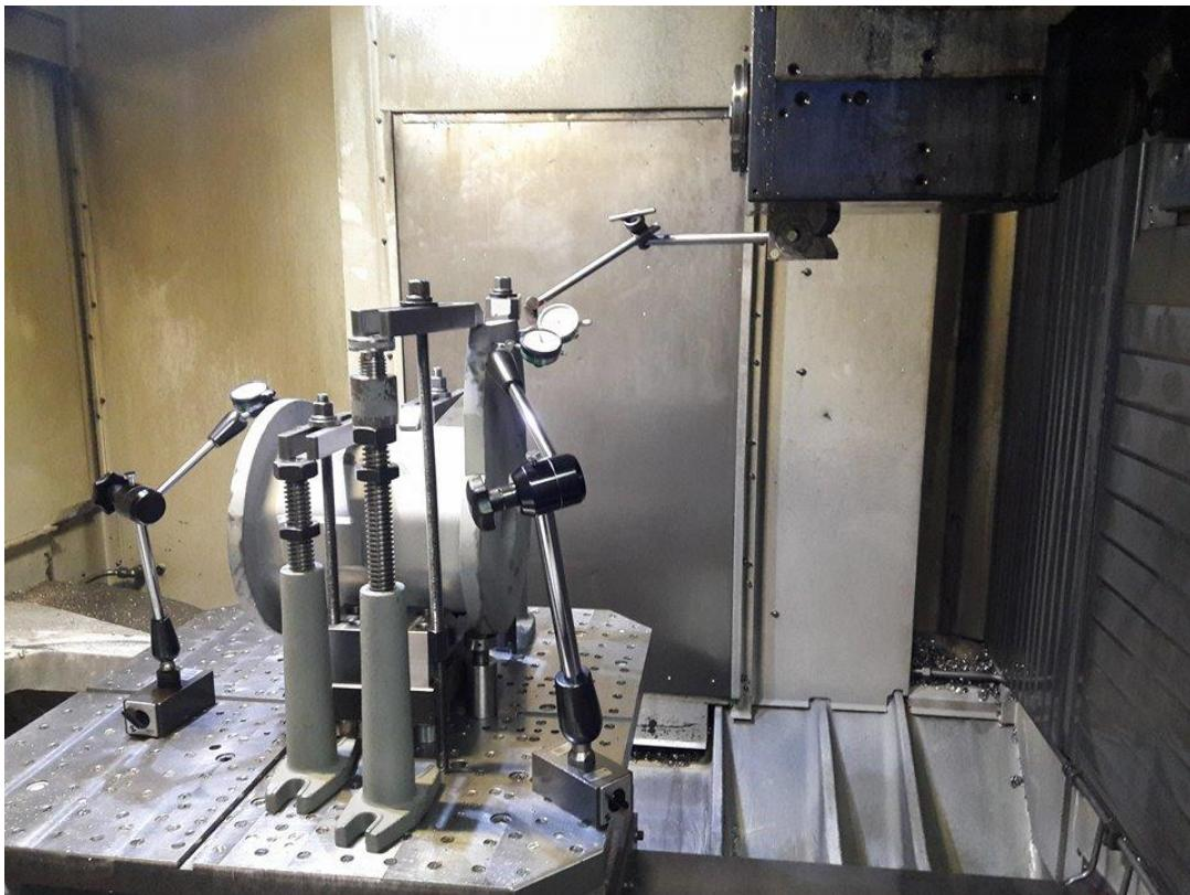
*Slika 15. Pozicioniranje proizvoda na stroju prije strojne obrade*
