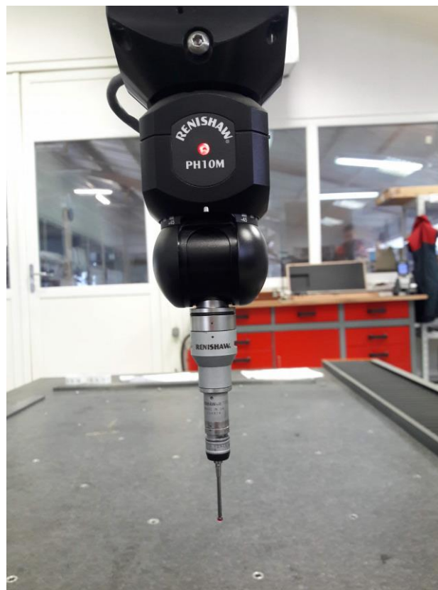
Slika 8. Mjerna glava Renishaw PH10M naTrokoordinatnom mjernom uređaju Metris iz tvrtke TMT
