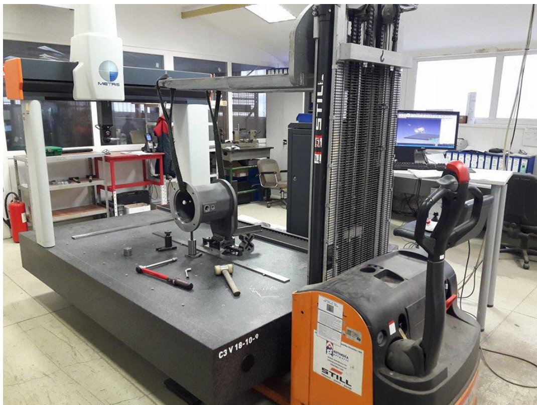
Slika 16. Postavljanje proizvoda na stol mjernog uređaja Metris
