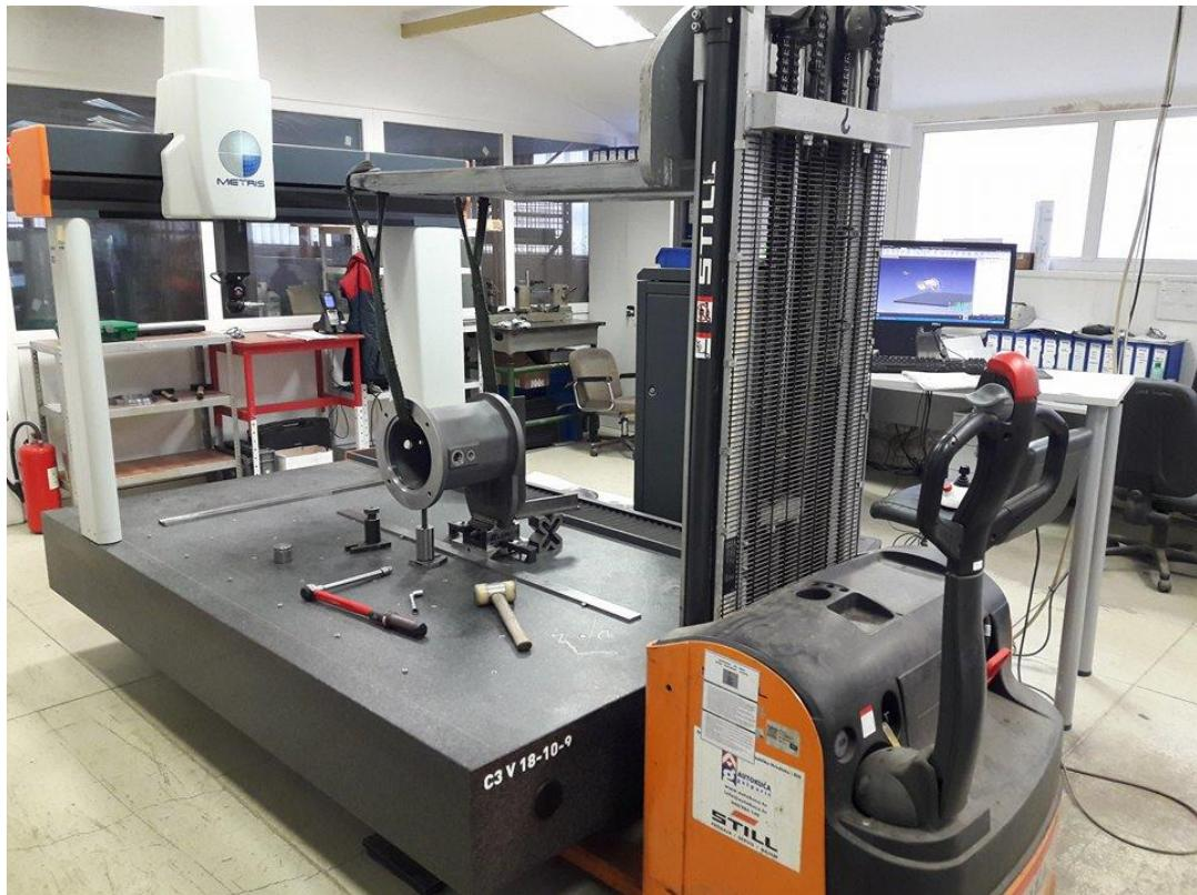
*Slika 16. Postavljanje proizvoda na stol mjernog uređaja Metris*
