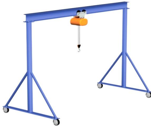
Slika 1.1. Manja radionička portalna dizalica
