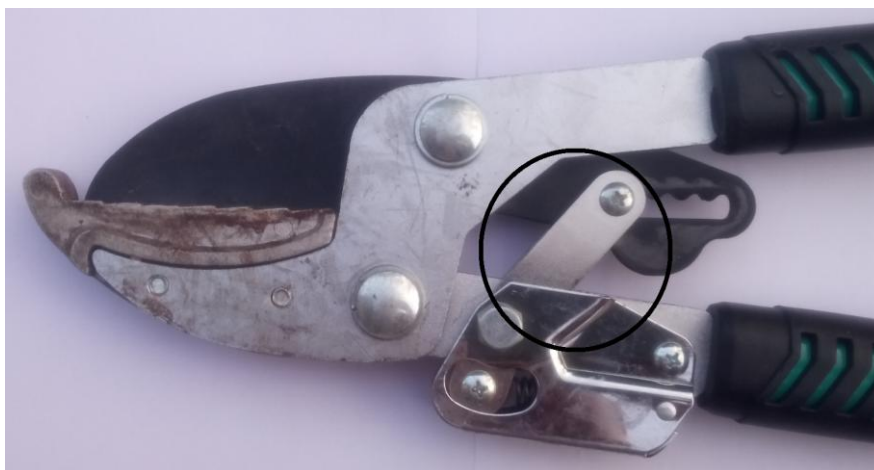
Slika 8.16: Prikaz polugice koja povezuje oštricu i ručku
