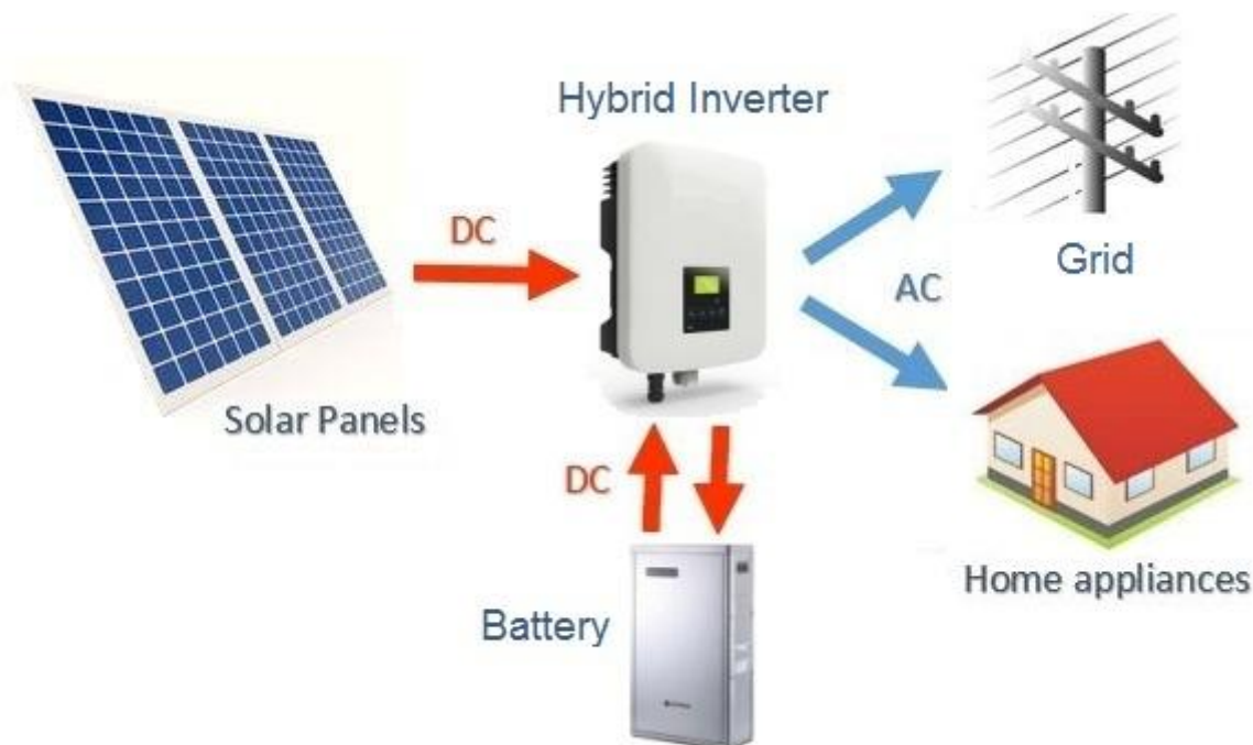
Slika 6.1: Jednostavan prikaz položaja hibridnog pretvarača u solarnom sustavu
