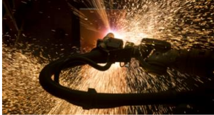
Slika 32. Plazma rezanje Strenx čelika [18]
