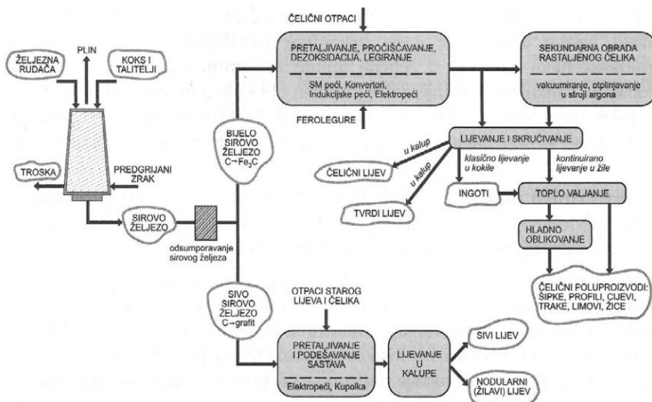
Slika 4. Shema dobivanja čelika i željeznih ljevova (1)
