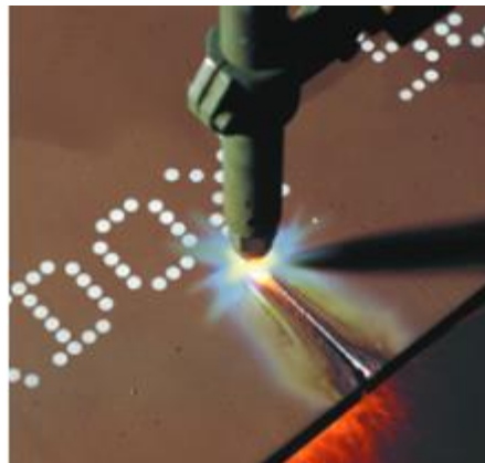
Slika 30. Plinsko rezanje Strenx čelika [18]
