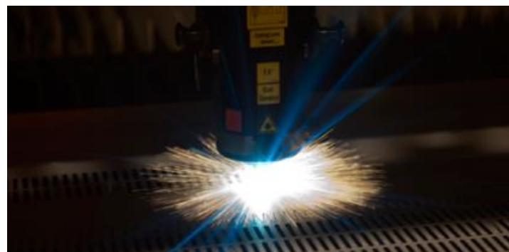
Slika 31. Rezanje laserom Strenx čelika [18]
