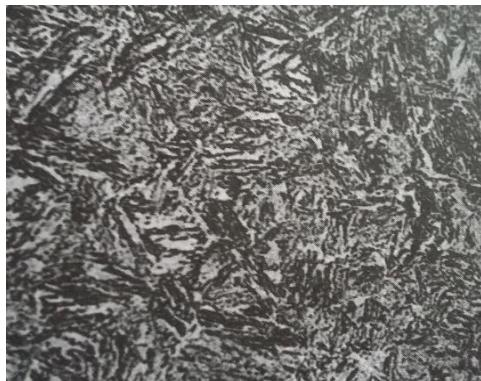
Slika 8. Mikrostruktura poboljšanog čelika- visokopopuštenog martenzita [1]
