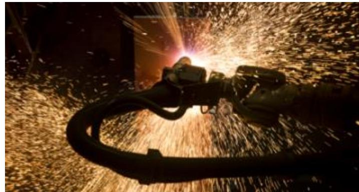
Slika 32. Plazma rezanje Strenx čelika [18]
