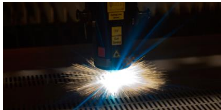
Slika 31. Rezanje laserom Strenx čelika [18]
