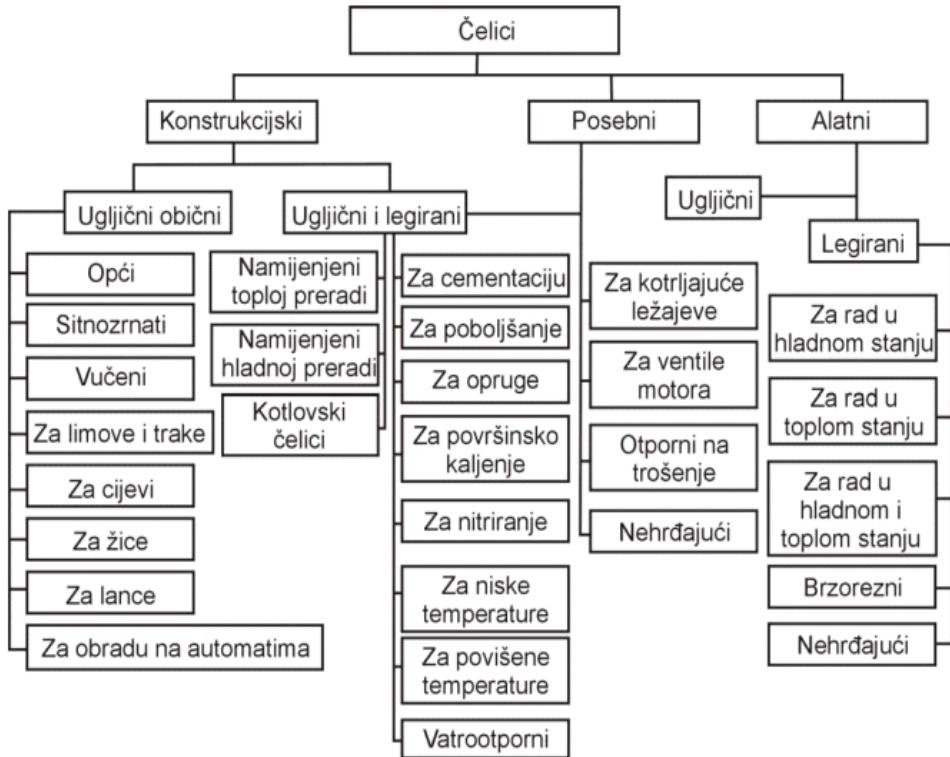
Slika 5. Podjela čelika prema namjeni [4]
