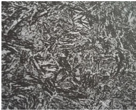
Slika 8. Mikrostruktura poboljšanog čelika- visokopopuštenog martenzita [1]
