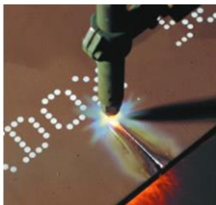
Slika 30. Plinsko rezanje Strenx čelika [18]
