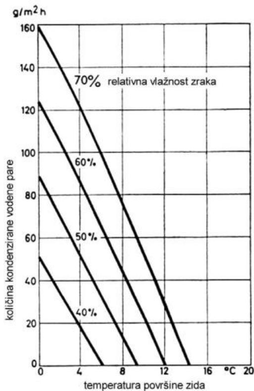
Slika 9. Prikaz relativne vlažnosti zraka pri temperaturi i količini kondenzirane vodene pare
