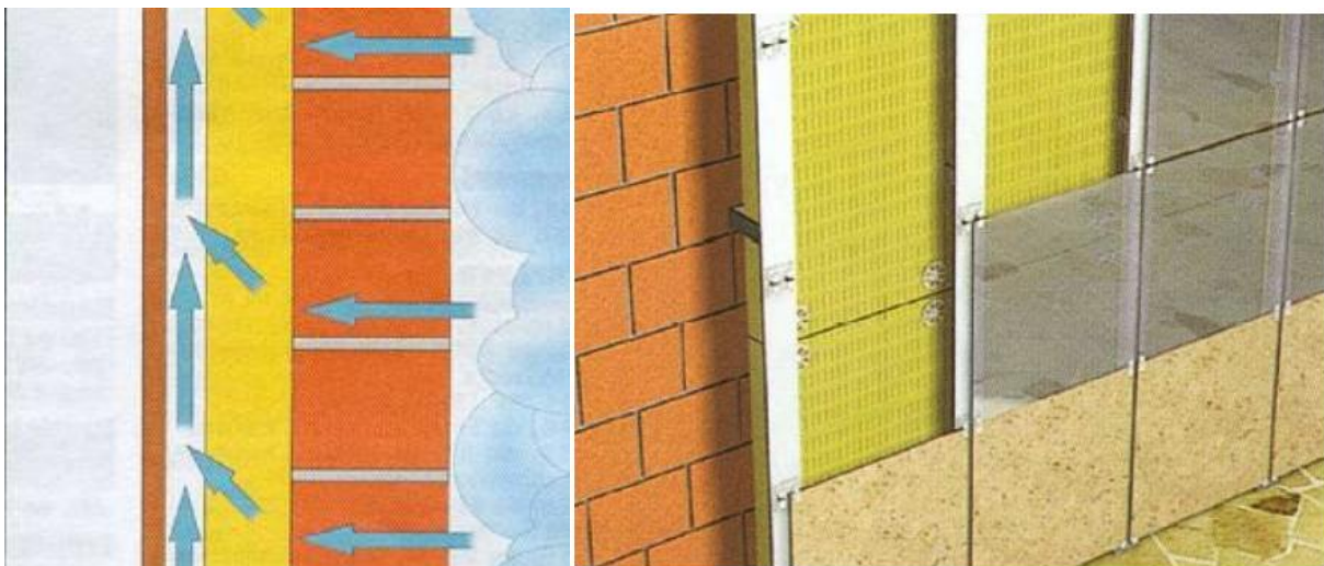
Slika 28., 29. Prikaz ventilirane fasade
