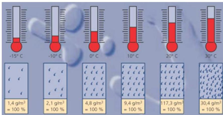
Slika 10. Količina absolutne vlage u  $\text{g/m}^3$  pri određenoj temperaturi
