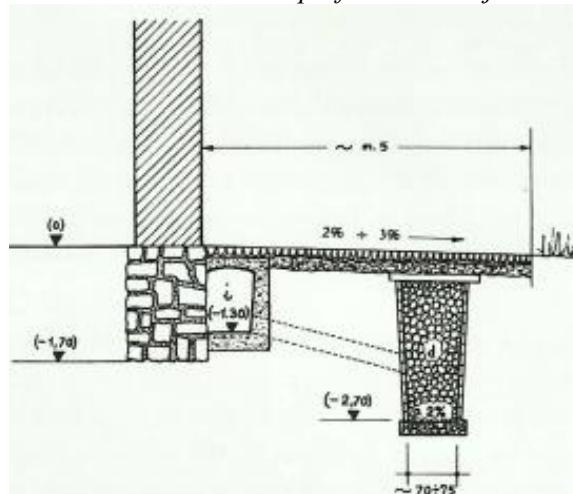
Slika 33. Zračni kanal sa odvodnjom prema bunaru
