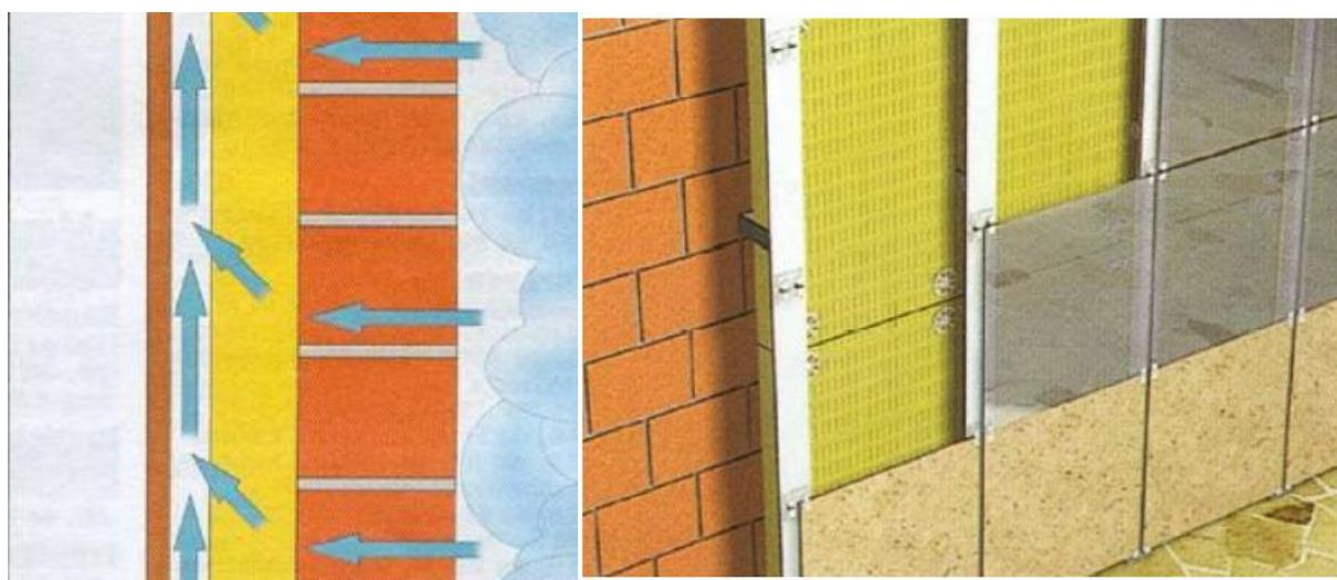
Slika 28., 29. Prikaz ventilirane fasade
