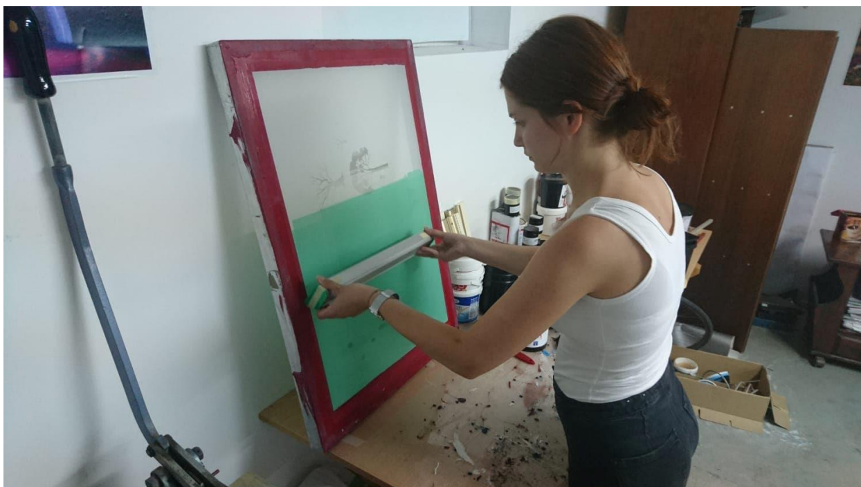
Slika 3.2 Nanošenje fotoosjetljive emulzije na svilu
