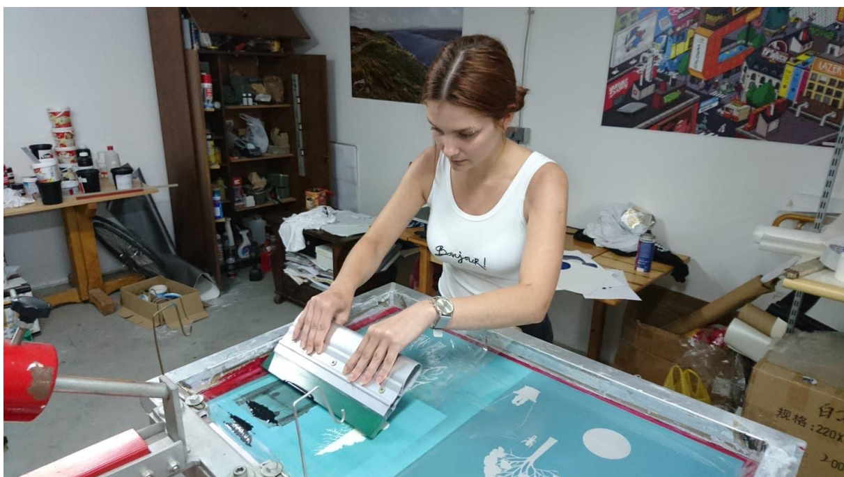
Slika 3.4 Tiskanje crne siluete na akvarel pozadinu kroz sitotisak
