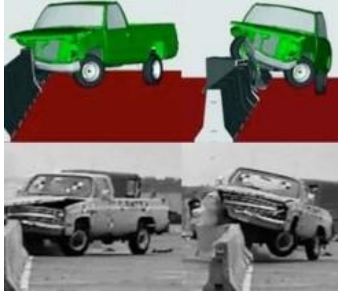
Slika 3.6 Prikaz simulacije "crash" testa [6]
