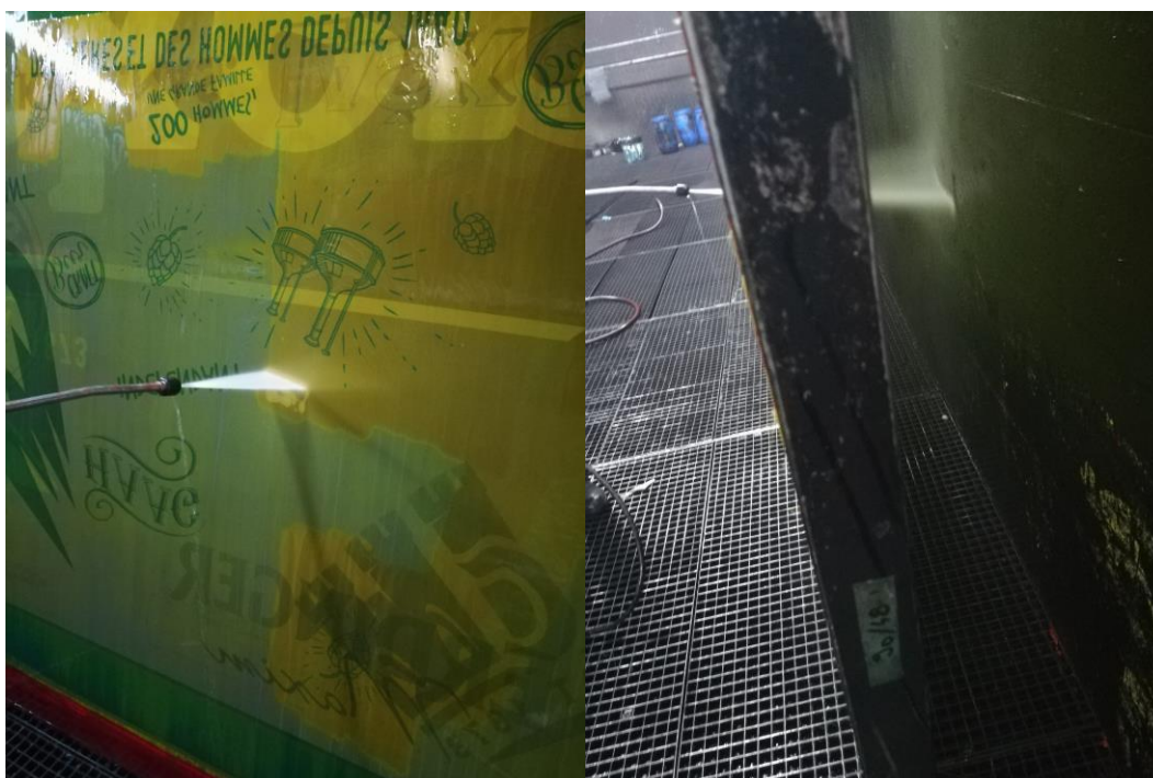
Slika 4.10.: Prikaz pranja prethodno nasnimanog dijela klišeja
