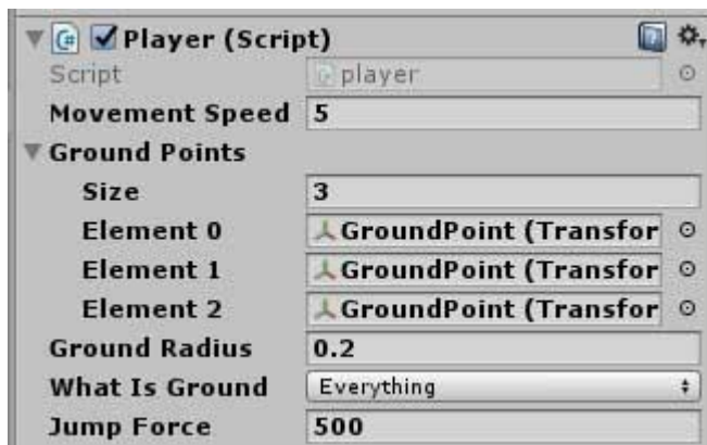
Slika 4.23 Korištene vrijednosti za „Ground Radius“ i skočnu silu
