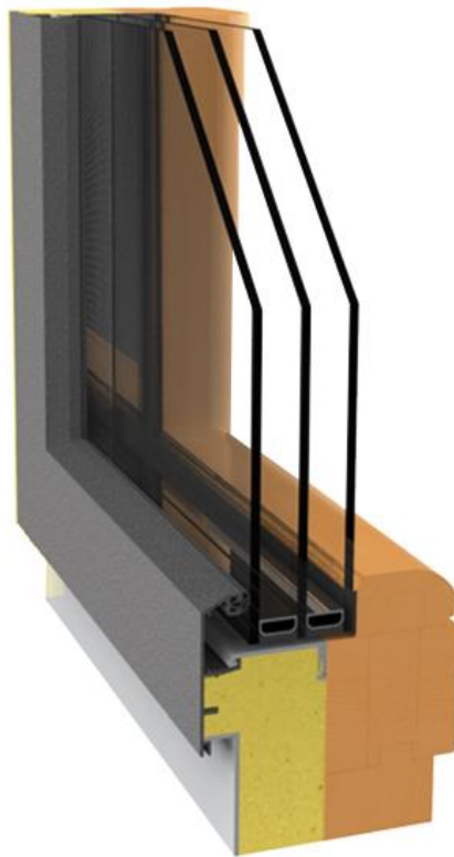
Slika 19. Prikaz troslojnog toplinsko izolacijskog prozora koji bi se trebao koristiti na ovom objektu
