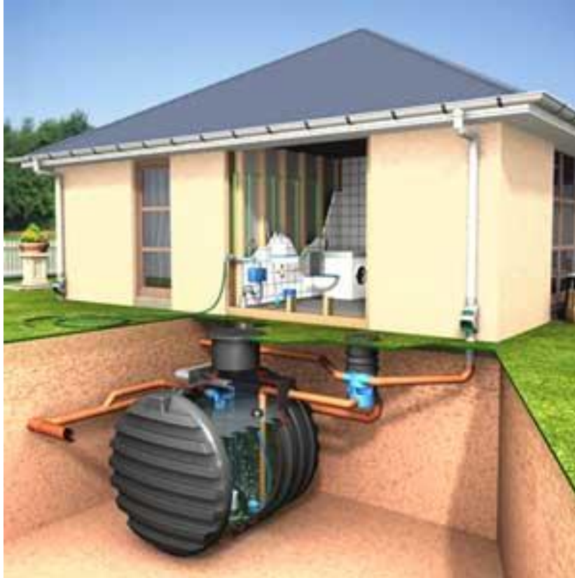
Slika 21. Detalj primanja i odvoza vode iz kišnice
